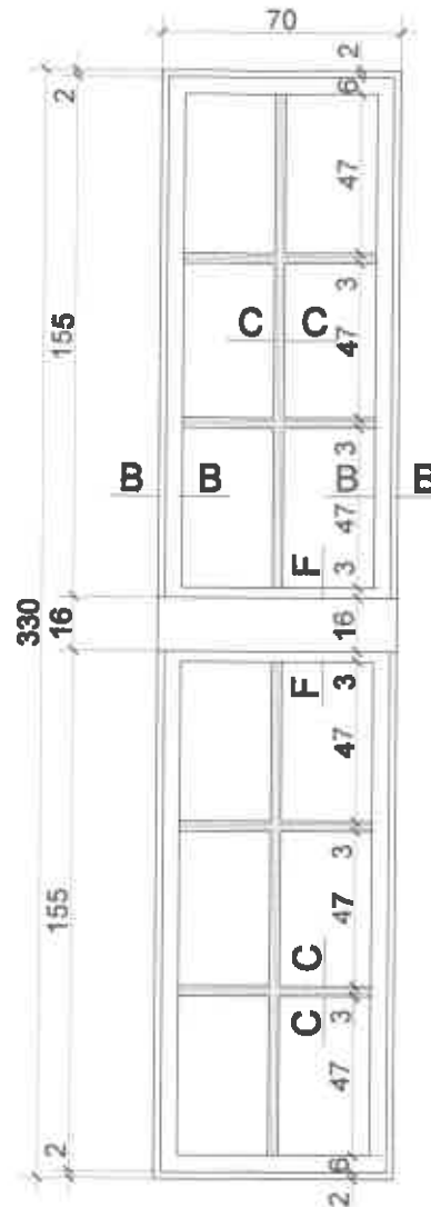
OKNO 07 - szt. 4 WIDOK ZEWNĘTRZNY (piętro, szczyty bud. gł.) skala 1:25
