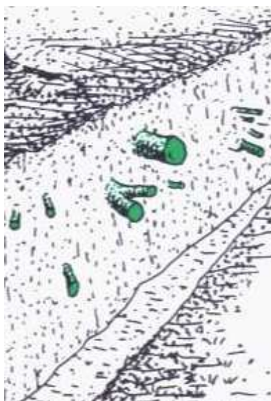
Rys 4 Postępowanie z korzeniami uszkodzonymi w wykopach. Przycięcie korzeni i zabezpieczenie środkiem do pielęgnowania ran (rys. pochodzi z European Treeworker , wyd. European Arbicultural Council )
