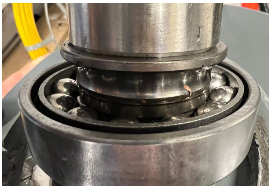
Rysunek 25 Uszkodzone łożysko w mechanizmie obrotowym
