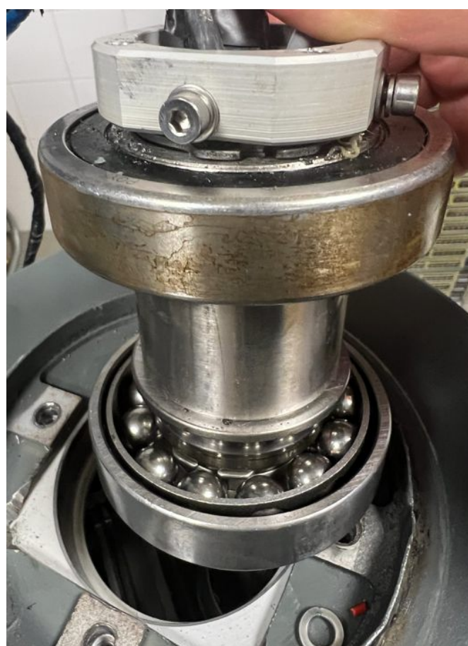
Rysunek 26 Mechanizm obrotowy - uszkodzenia
