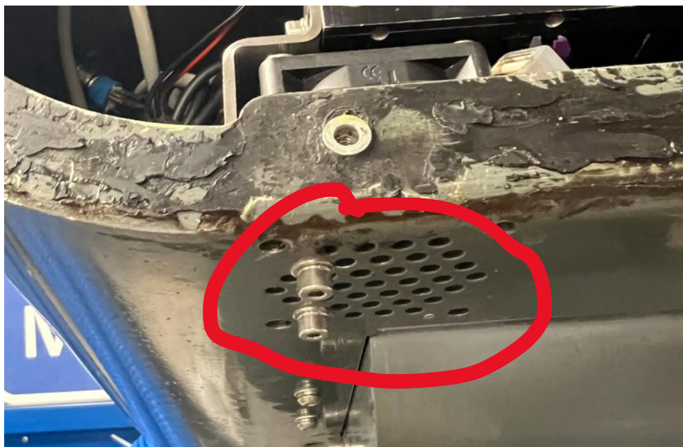
Rysunek 11 Zaklejone otwory wentylacyjne głowicy – widok z zewnątrz
