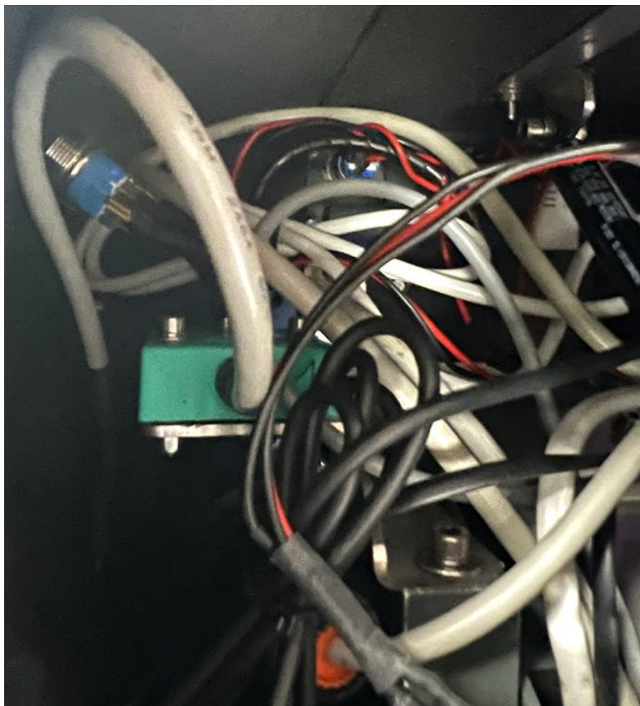
Rysunek 16 Upchnięte i splątane kable w głowicy lunety 1
