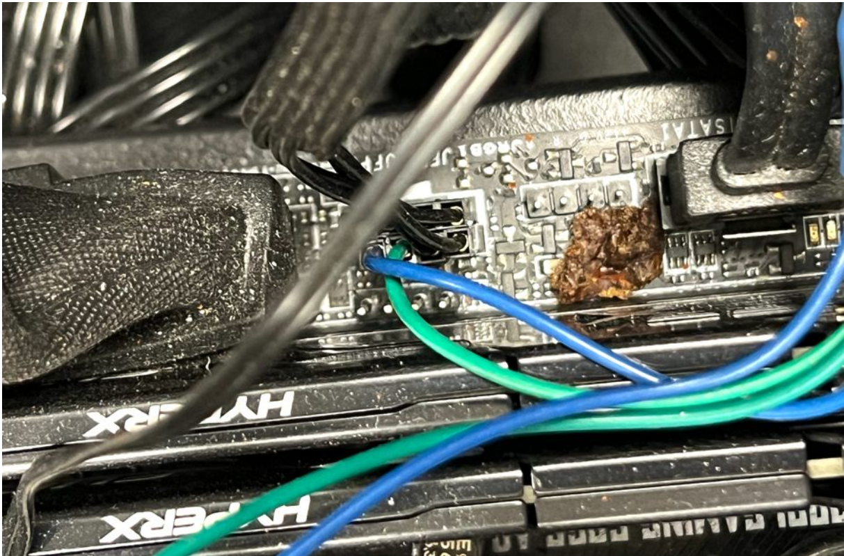
Rysunek 15 Brud na płycie głównej komputera
