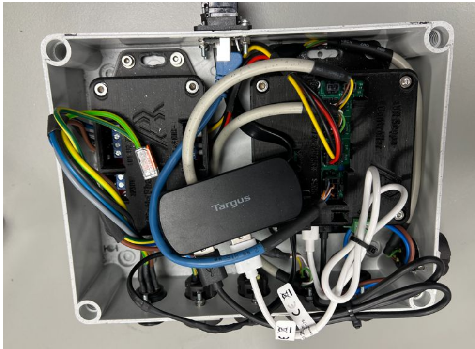
Rysunek 18 Upchnięte i splecione kable w skrzynce dolnej
