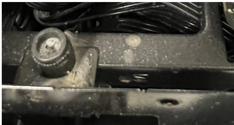
Rysunek 14 Ślady wody na elementach komputera
