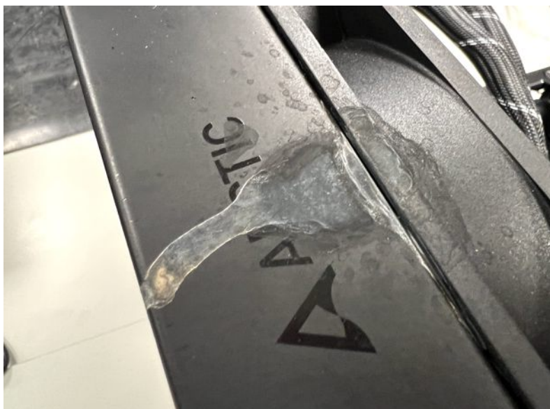
Rysunek 13 Ślady wody na elementach komputera – chłodnica
