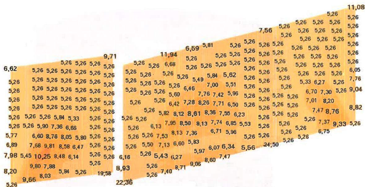
Ściana wewnętrzna: zbrojenie pionowe (dolne) [cm 2 / m]
