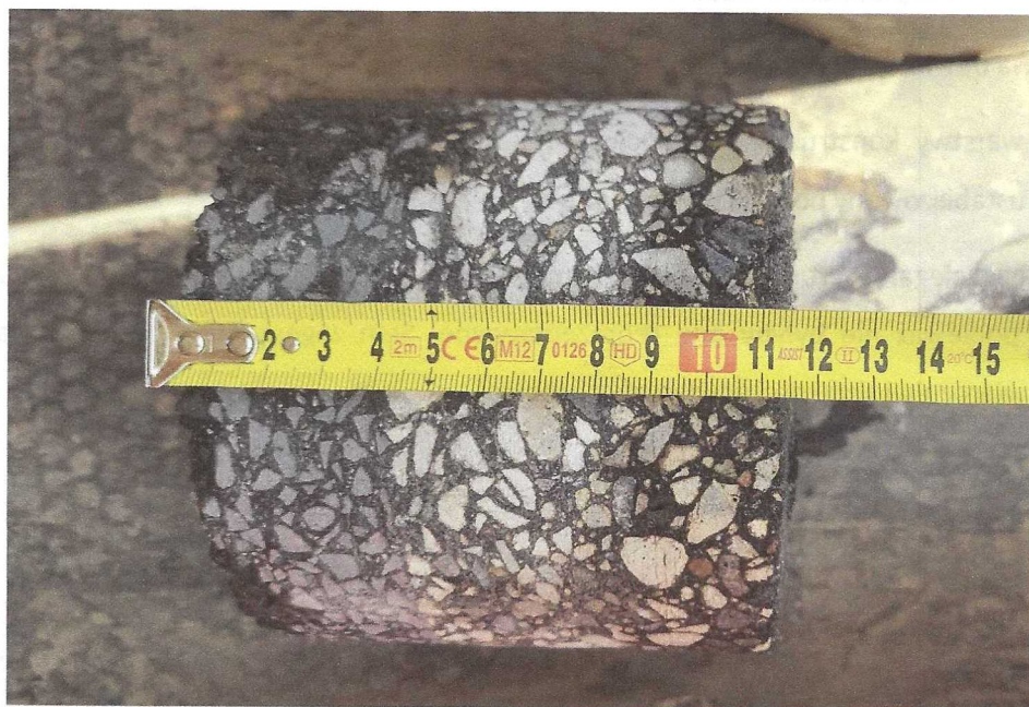
Fot. nr 1: Odwiert w warstwach nawierzchni z mieszanek mineralno- asfaltowych w punkcie nr 1.
