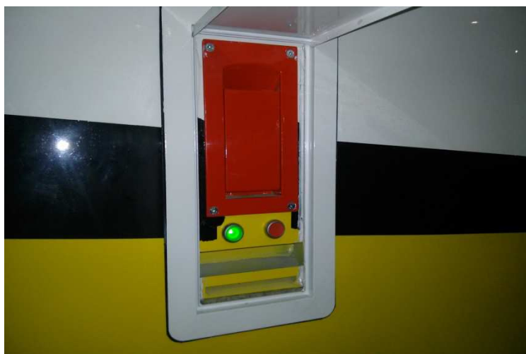
Rys.1 Widok przycisków zał. i wył. baterii z zewnątrz pojazdu.
