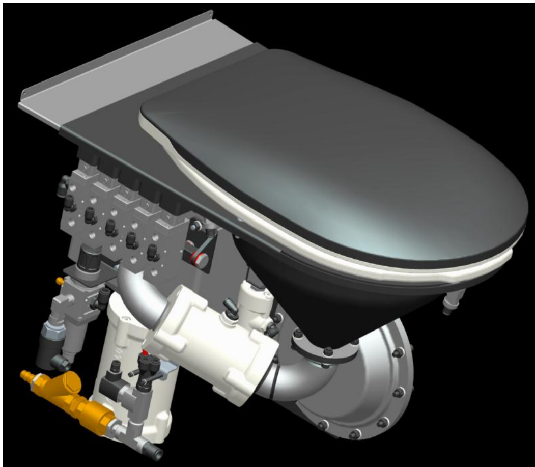
Rys. 3 TOALETA Z OPUSZCZONYMI KLAPAMI BEZ OBUDOWY, WIDOK OGÓLNY 3D
