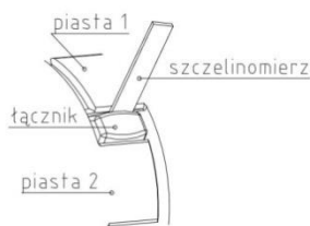
Rysunek 20. Kontrola zużycia łącznika sprzęgła elastycznego
