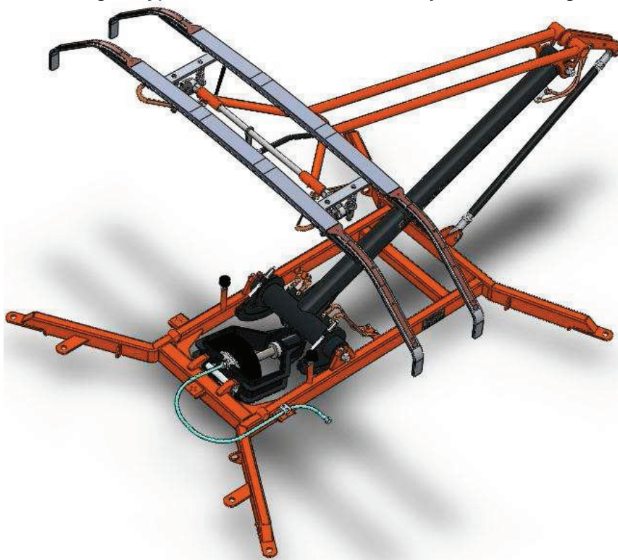
Fot. 1. Pantograf typu 160EC – widok od strony układu dźwigniowego
