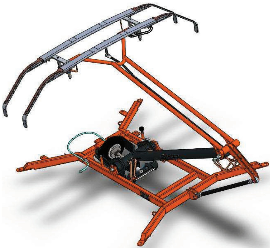
Fot. 1. Pantograf typu 160EC – widok od strony układu dźwigniowego
