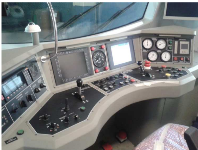
Rys. 5 Widok umieszczenia stacyjki załączenia rozrządu.
