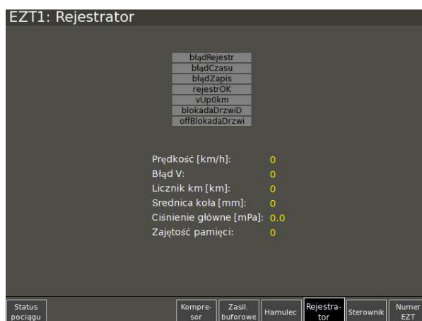
Rys. 28 Strona diagnostyczna rejestratora (zakładka „Sterowniki” ze strony głównej).
