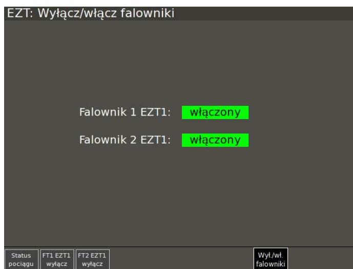
Rys. 12 Sygnalizacja załączonych falowników (zakładka „Falowniki” na stronie głównej).
