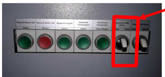
Rys. 15 Widok tablicy w szafie nn z zaznaczonymi przyciskiem wyłączania systemu przeciwoślizgu (ABS).
