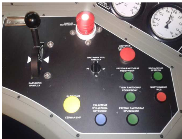
Rys. 7 Miejsce umieszczenia klawisza załączenia WS.
