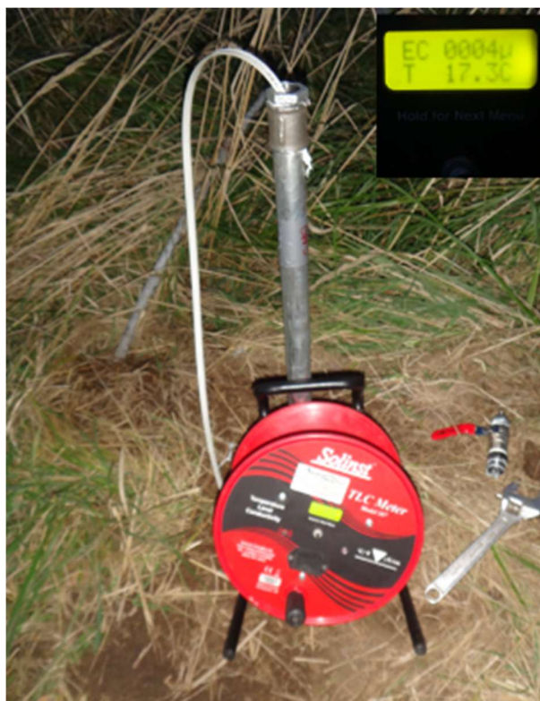
Fot. 14 Pomiar temperatury w sondzie gazowej
