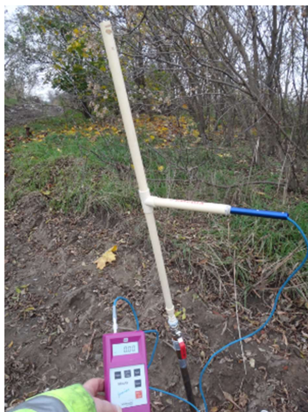
Fot. 11 Pomiar prędkości przepływu gazu w sondzie
