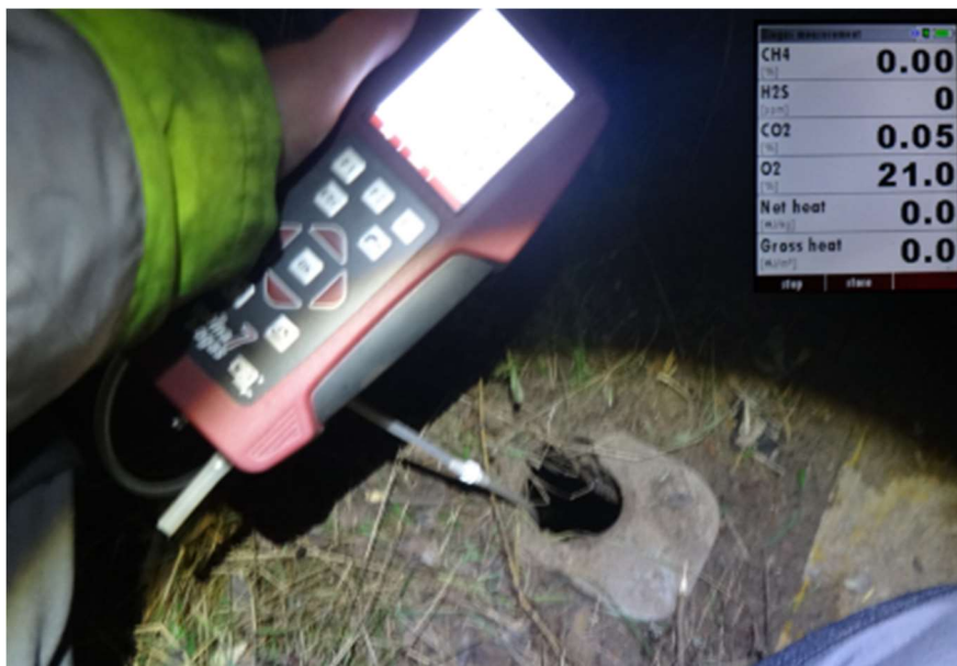
Rysunek 7 Pomiar składu gazu w studni odciekowej S-2
