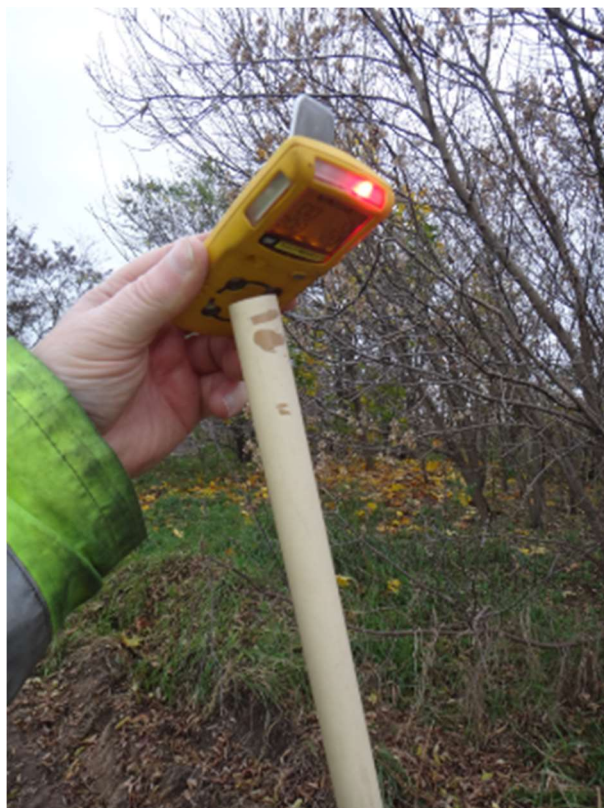
Fot. 18 Dowód na przepływ gazu mimo zerowego wskazania anemometru
