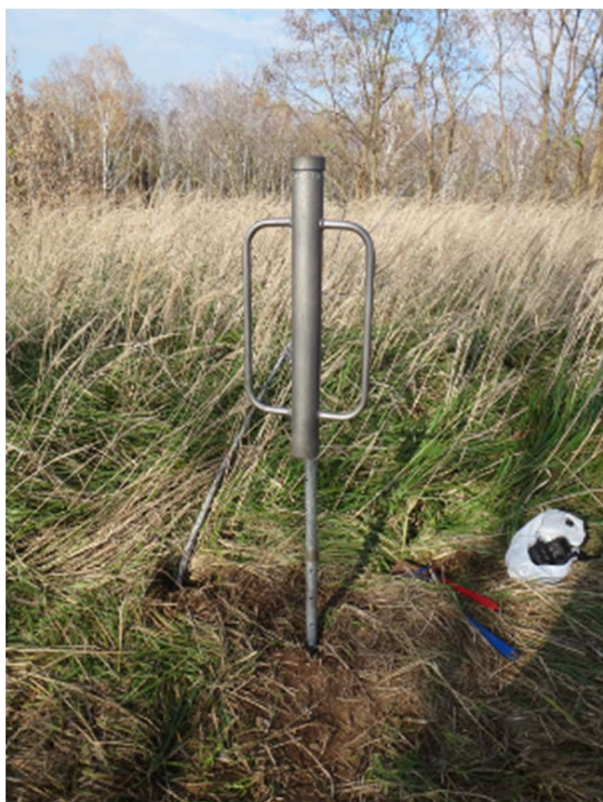
Fot. 6 Instalacja sondy gazowej GW5
