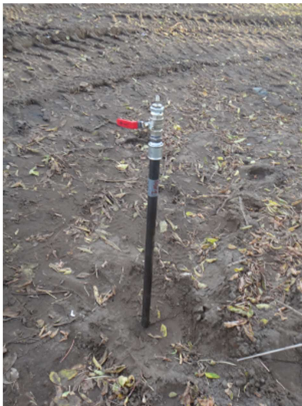
Fot. 5 Zainstalowana sonda gazowa GW1
