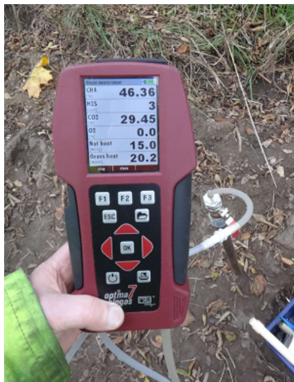
Fot. 10 Pomiar składu gazu w sondzie
