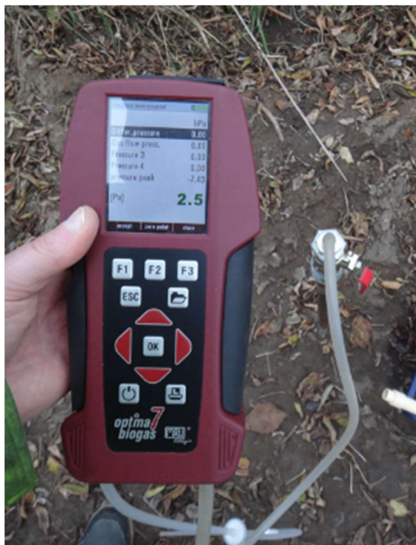
Fot. 8 Pomiar ciśnienia gazu w sondzie (1)
