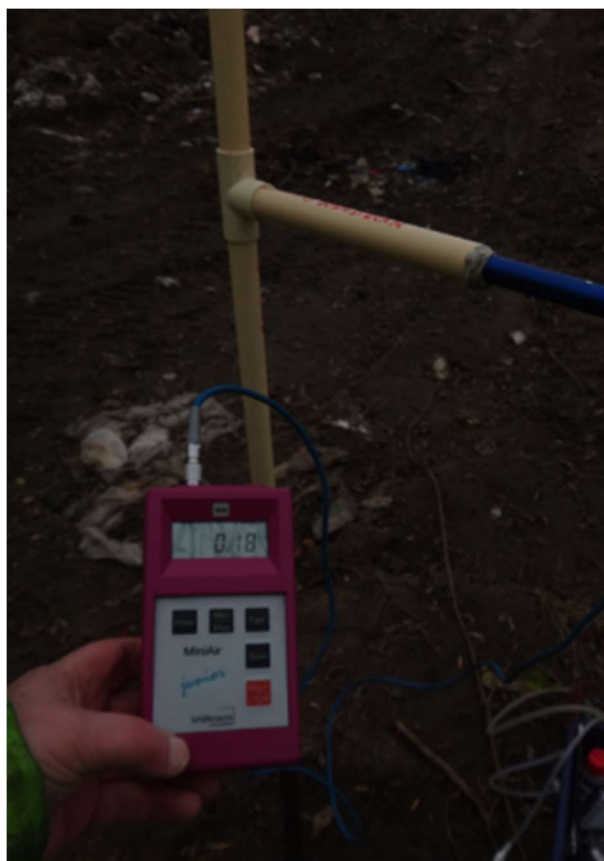
Fot. 12 Pomiar prędkości przepływu gazu w sondzie GW2 (epizod 0,18 m/s)
