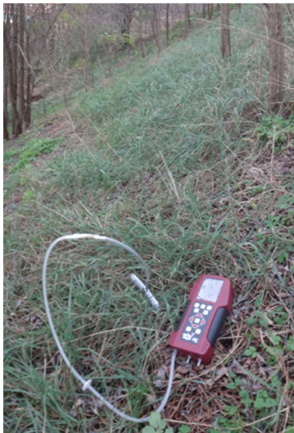
Fot. 15 Pomiar sondą penetracyjną na skarpie hałdy
