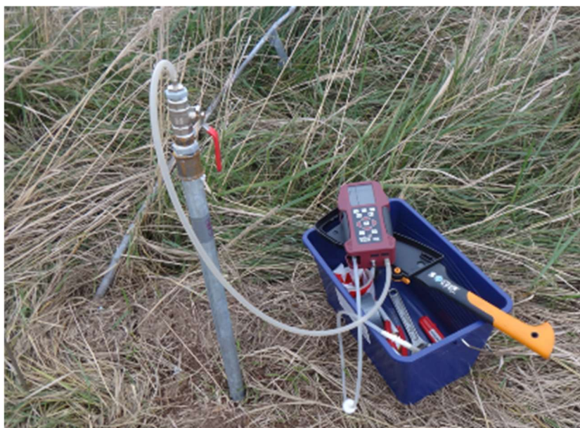
Fot. 9 Pomiar ciśnienia gazu w sondzie (2)
