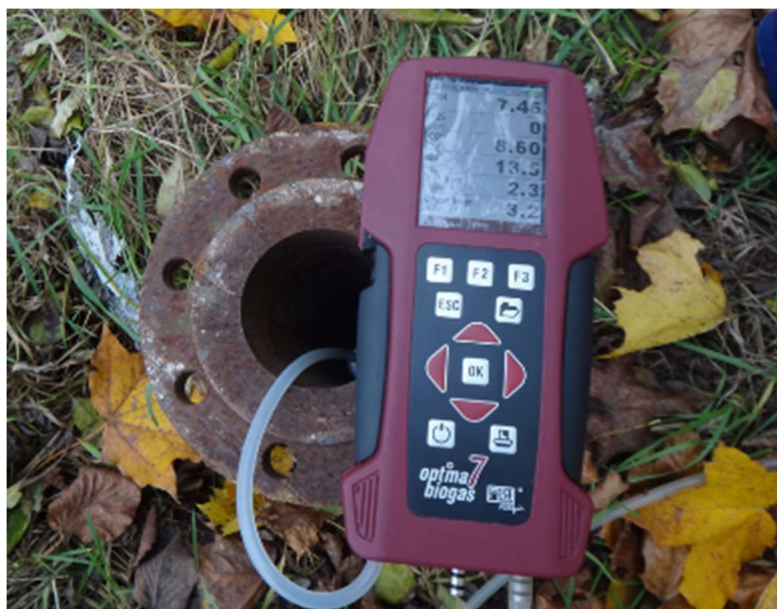
Fot. 13 Pomiar składu gazu w sondzie GW7
