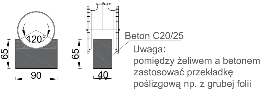
SCZEGÓŁ BETONOWEJ PODPORY
