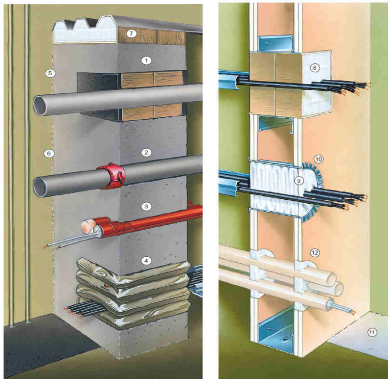
Rys. 2. Zabezpieczone przepusty instalacyjne
