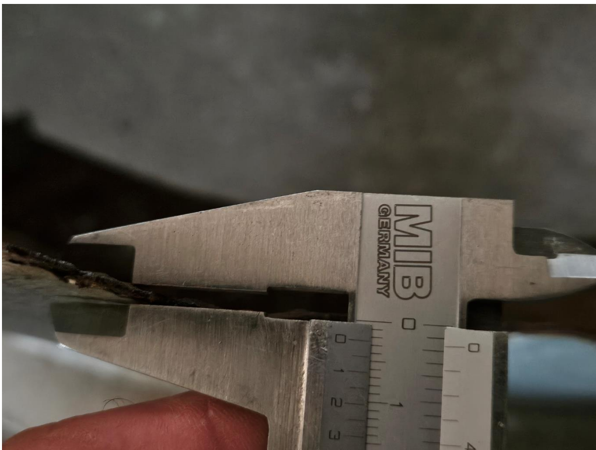
Fot. 16 Pomiar grubości blachy nośnej mocyjacej „kłos” do słupa, grubość nominalna to 12mm, jest 2,3mm.
