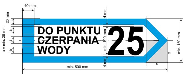
Oznakowanie dojazdu do punktu czerpania wody z dróg publicznych wewnątrz kompleksu leśnego – wymiary minimalne.
