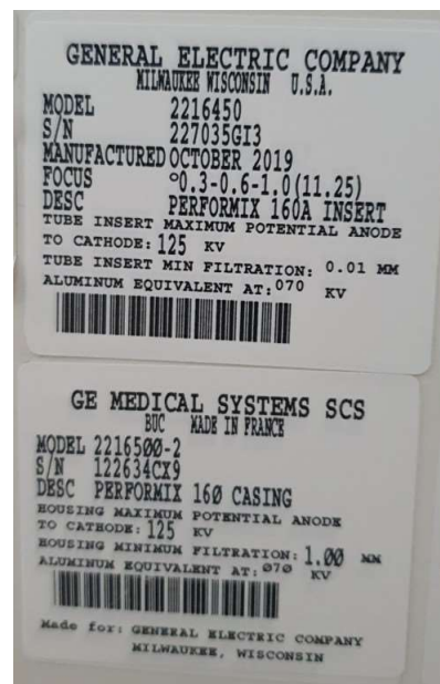
Oznakowanie angiografu, lampy RTG, pozycjonera kolimatora
