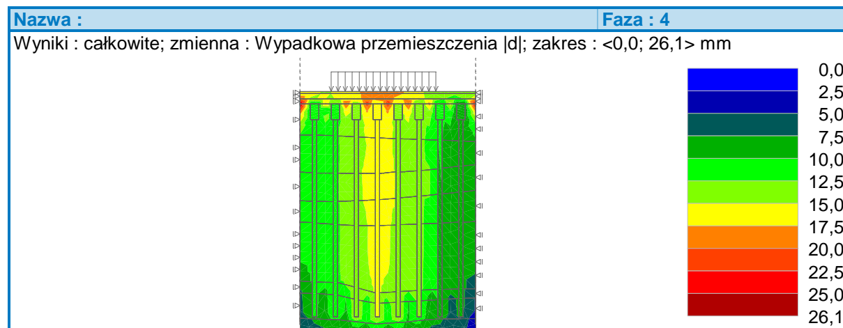
Rys 2. Osiadanie placu/ kolumn betonowych [mm]
