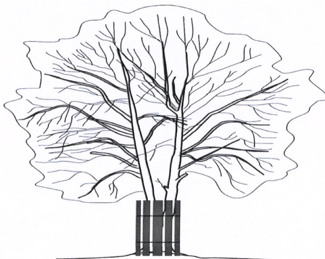
Ryc. 9. Poglądowy rys. zabezpieczenia pnia drzewa.
