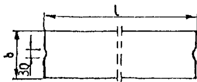
Rys. 1. Wymiarowanie obrzeży (oporników)
