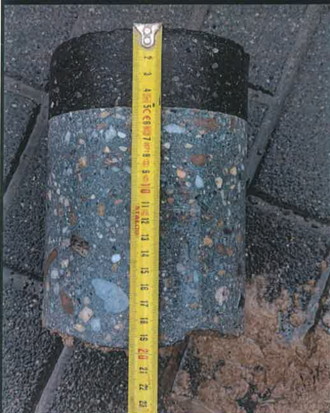
Układ warstw konstrukcji posadzki
