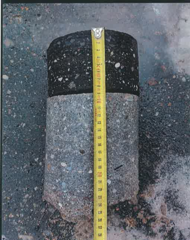
Układ warstw konstrukcji posadzki
