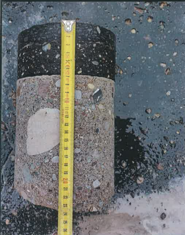
Układ warstw konstrukcji posadzki
