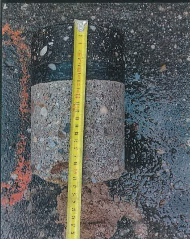
Układ warstw konstrukcji posadzki
