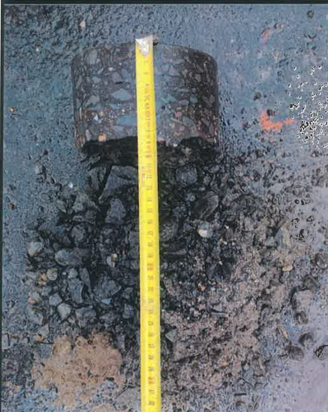
Układ warstw konstrukcji posadzki
