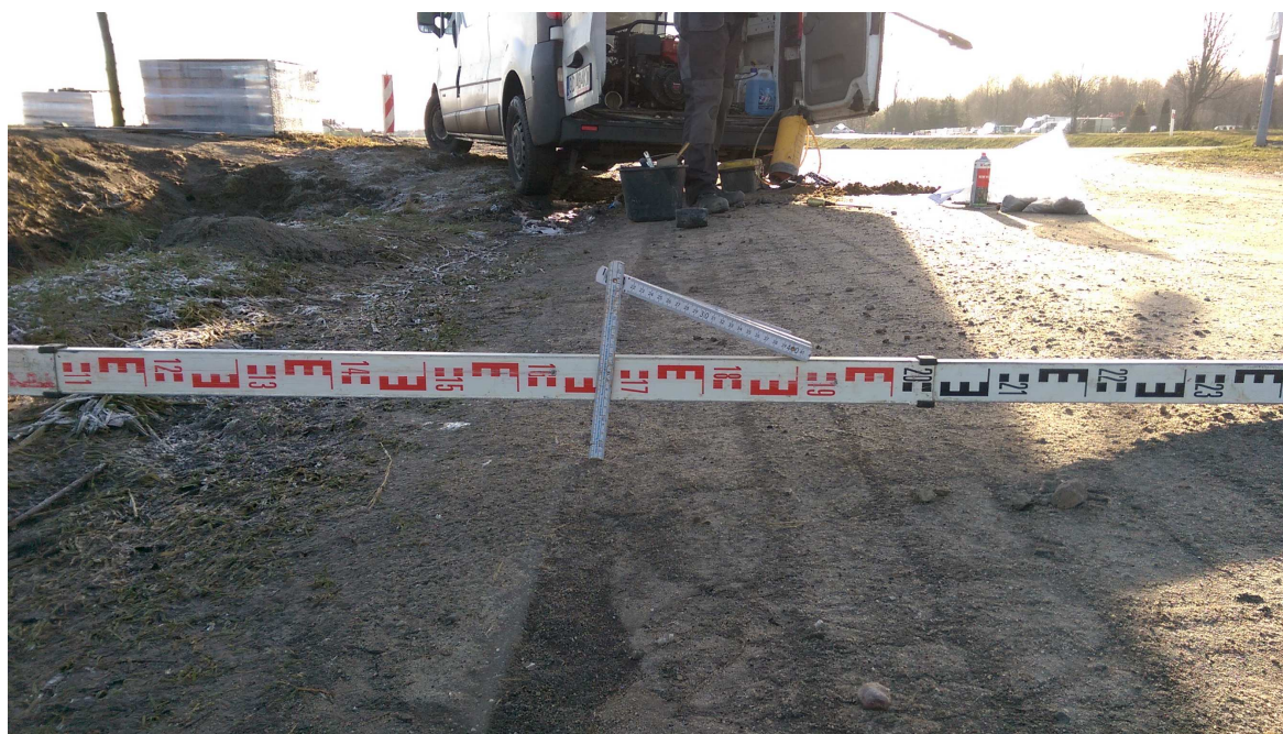
Fot. 2 Osiadania nawierzchni wzdłuż krawędzi drogi
