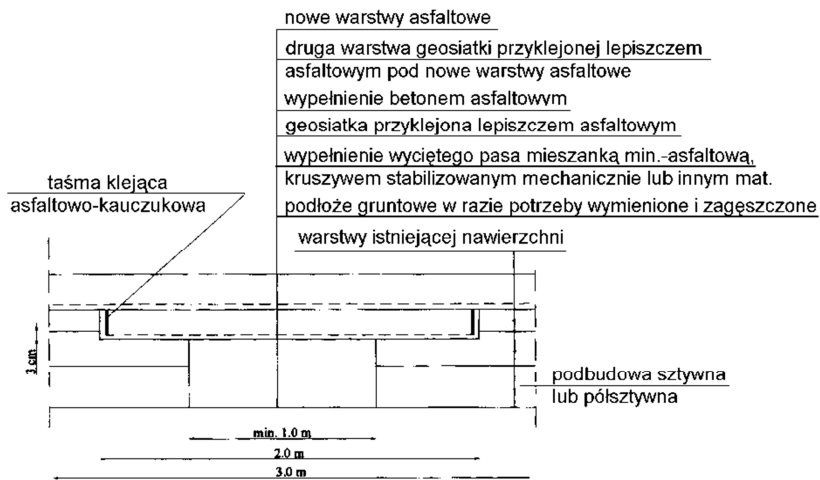
Rys. 5. Naprawa powierzchniowa pęknięć odbitych z ułożeniem nowych warstw asfaltowych
