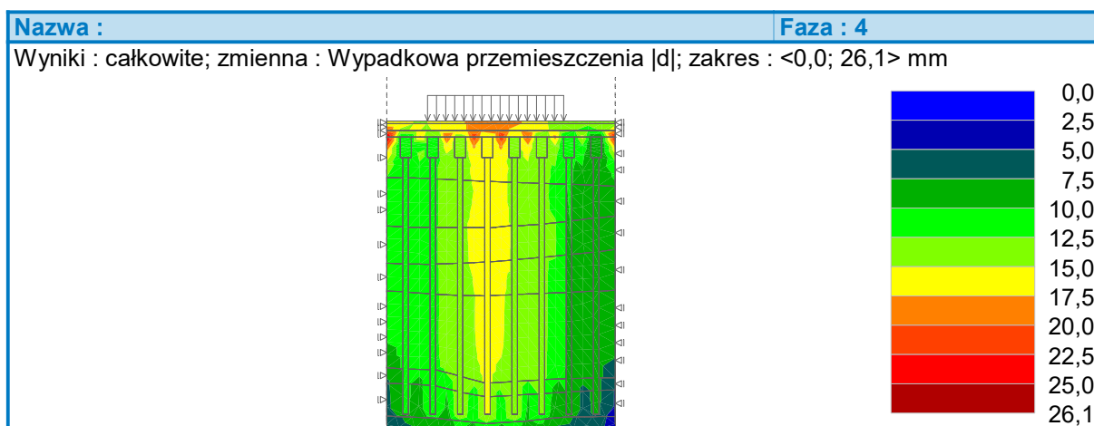
Rys 2. Osiadanie placu/ kolumn betonowych [mm]
