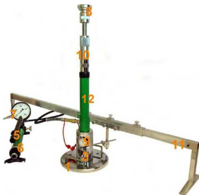
Rys. 1.1. Aparatura VSS z trzypunktowym pomiarem przemieszczenia płyty
