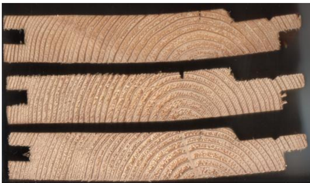
Fot.2. Czoła badanych próbek z elementów elewacji – widoczna wyrównana słoistość i wyraźna krzywizna poprzeczna płaszczyzn (łódkowanie)
