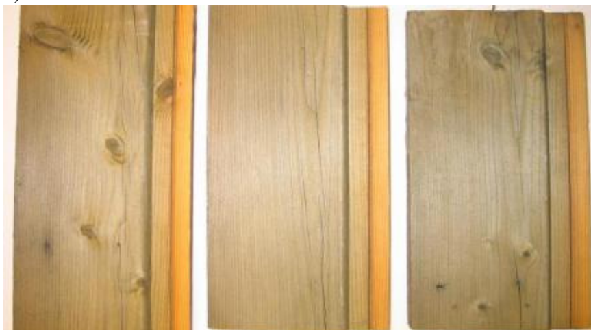
Fot.1. Dostarczone próbki drewna do badań identyfikacyjnych: a) z elementów elewacji, b) porównawczo z deski elewacyjnej z magazynu (przekrój promieniowy)
