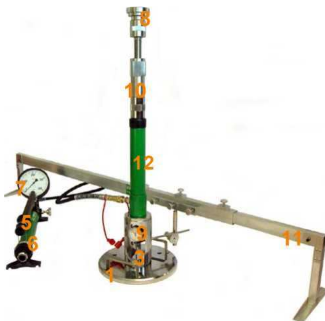
Rys. 1.2 Aparatura VSS z jednopunktowym pomiarem przemieszczenia płyty
