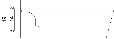
widok z boku szprosa wewnętrznego z wyfrezowanym kontrprofilem
