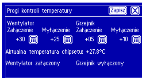
rys. 58. Ekran kontroli temperatury
