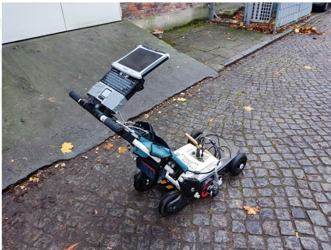
Zdjęcie 1 Georadar RIS-S wykorzystany w trakcie pomiarów.
