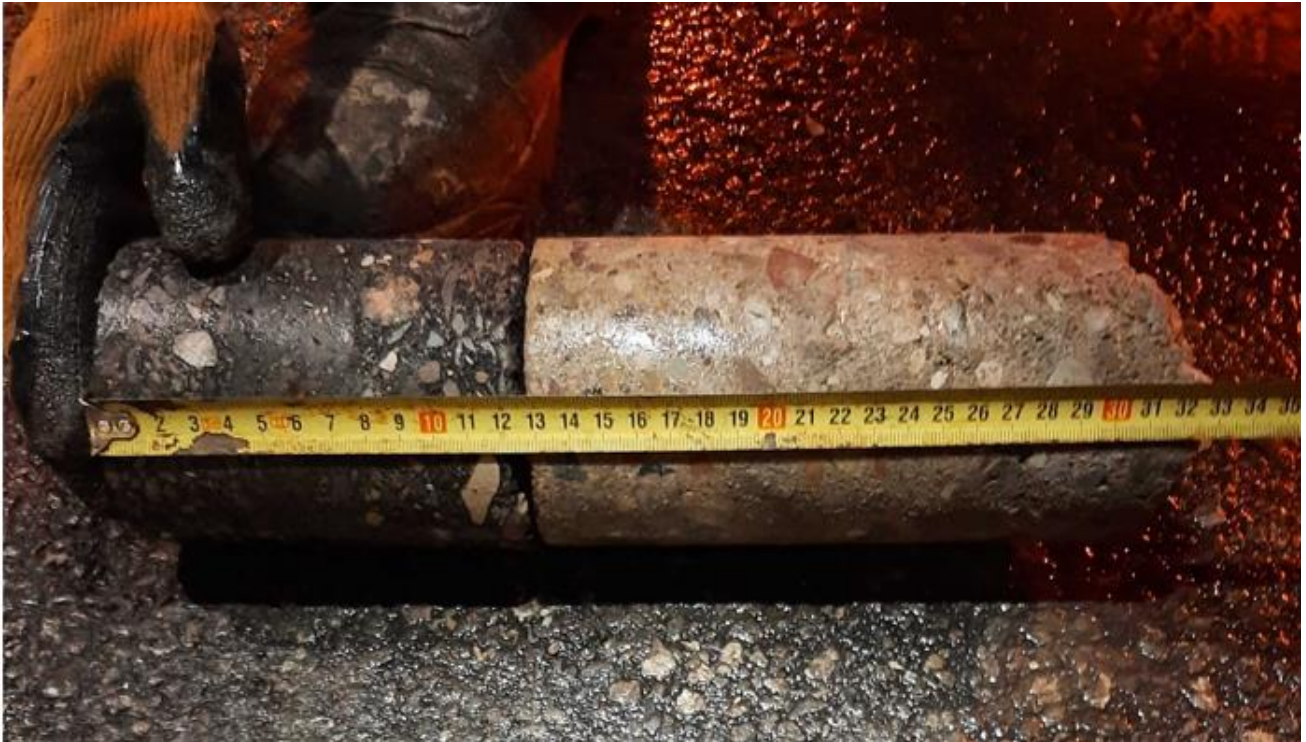
Fot. 1. Rdzeń pobrany z nawierzchni drogowej
