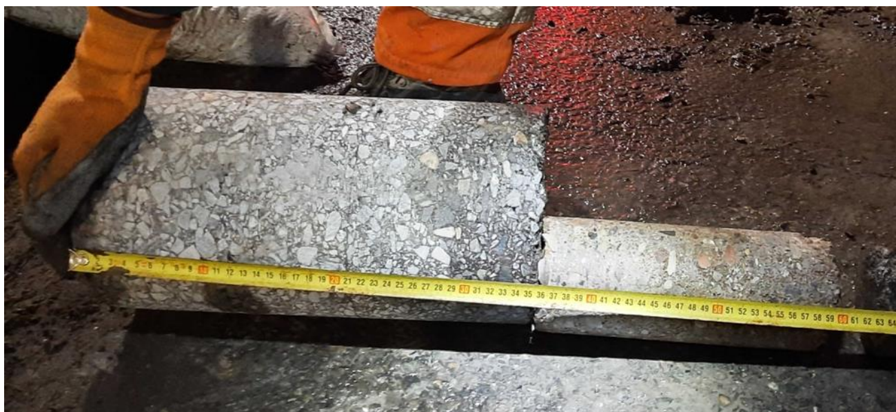
Fot. 3. Rdzeń pobrany z nawierzchni drogowej
