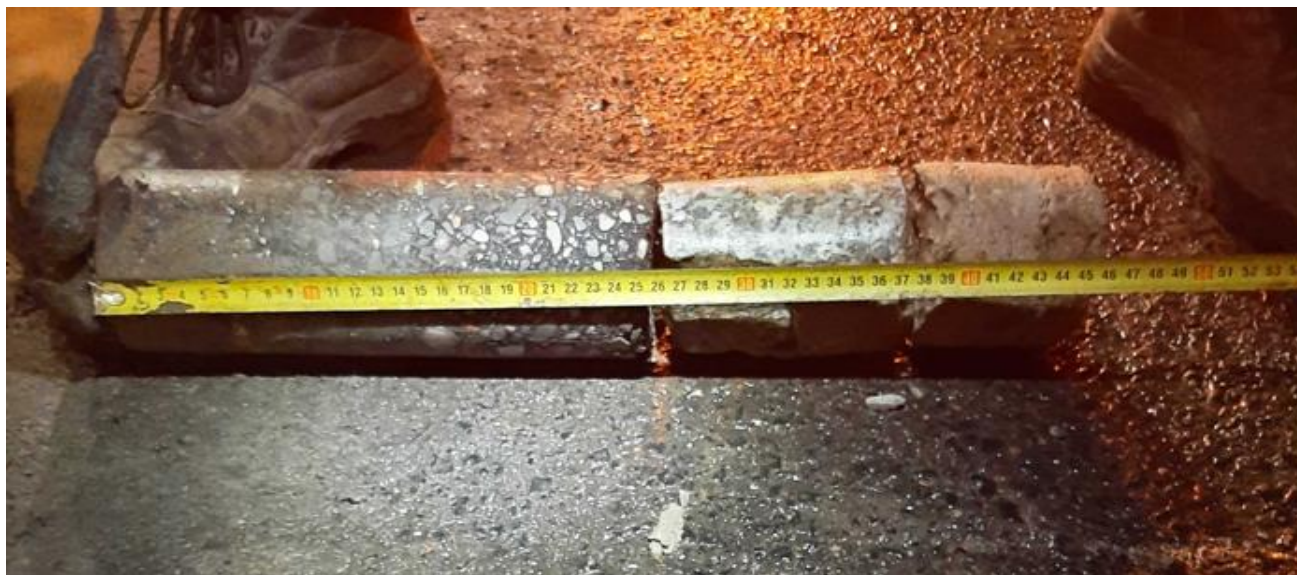
Fot. 2. Rdzeń pobrany z nawierzchni drogowej
