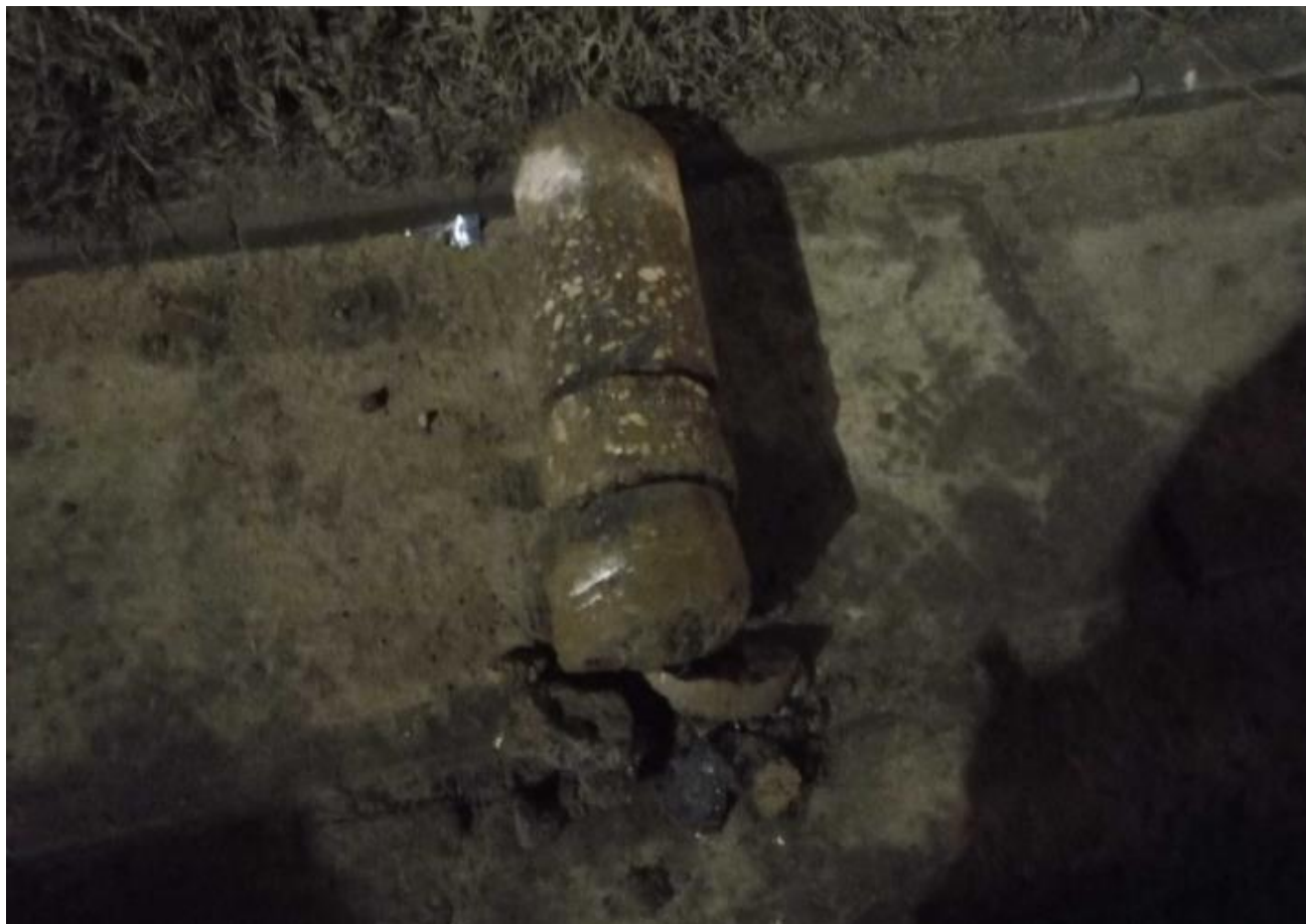
Fot. 5. Rdzeń pobrany z nawierzchni drogowej
