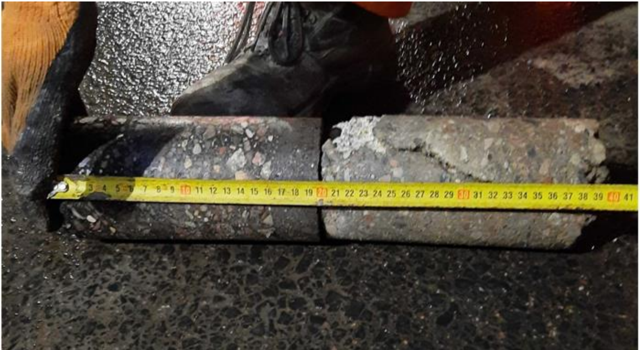
Fot. 4. Rdzeń pobrany z nawierzchni drogowej
