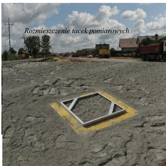
Tacka pomiarowa ze spoiwem rozłożonym na powierzchni 0,5 m 2
