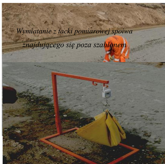
Ważenie tacki pomiarowej ze spoiwem
