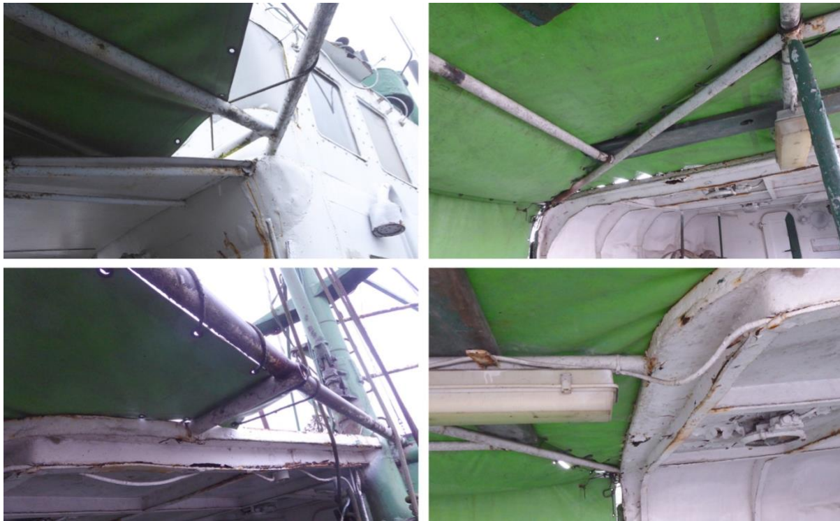
II.04. Detale łączenia stelażu plandeki z nadbudówką.
