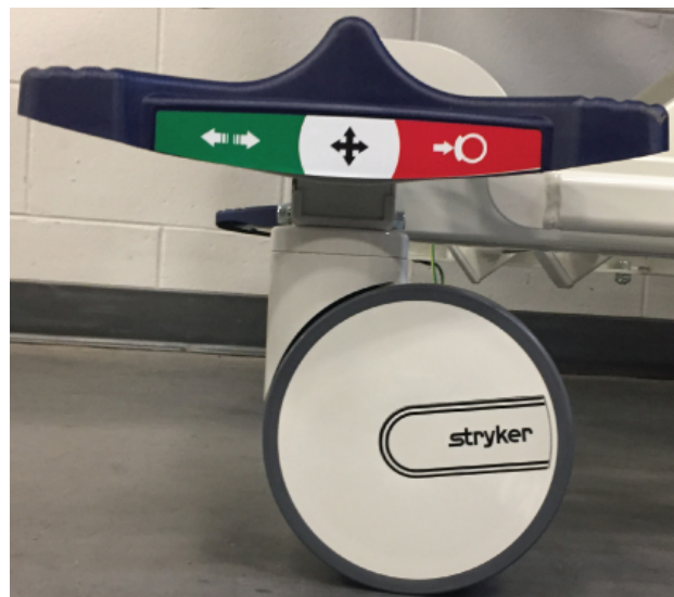
Figura 2-10: Liberación del pedal de dirección
