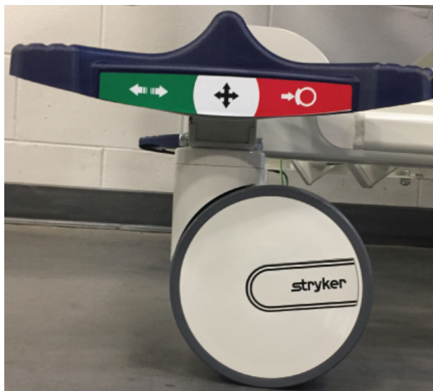
Obrázek 15-10: Uvolnění pedálu řízení
