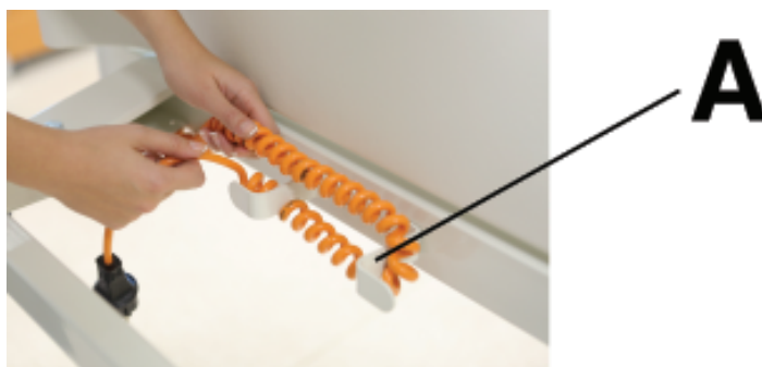
Εικόνα 13-6: Φύλαξη του καλωδίου ρεύματος
