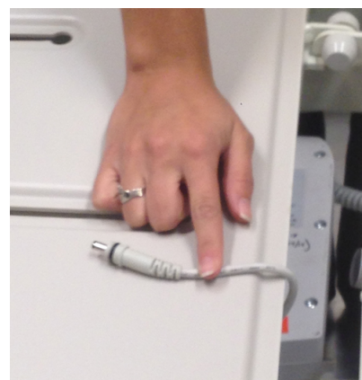
Fig. 9-5: Frakobling af batterikablet fra kontrolboksen
