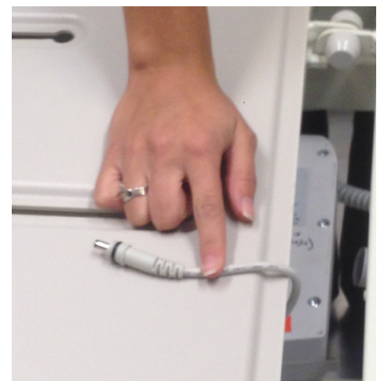
그림 14-5: 배터리 케이블을 컨트롤 상자에서 빼기
