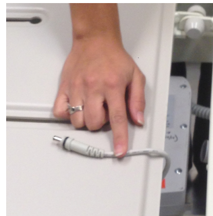
Figura 2-5: Desconexión del cable de la batería de la caja de control
