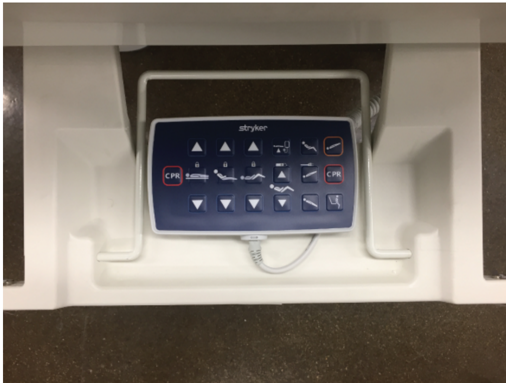
Figura 4-21: Conservazione della pulsantiera di comando per l'infermiere
