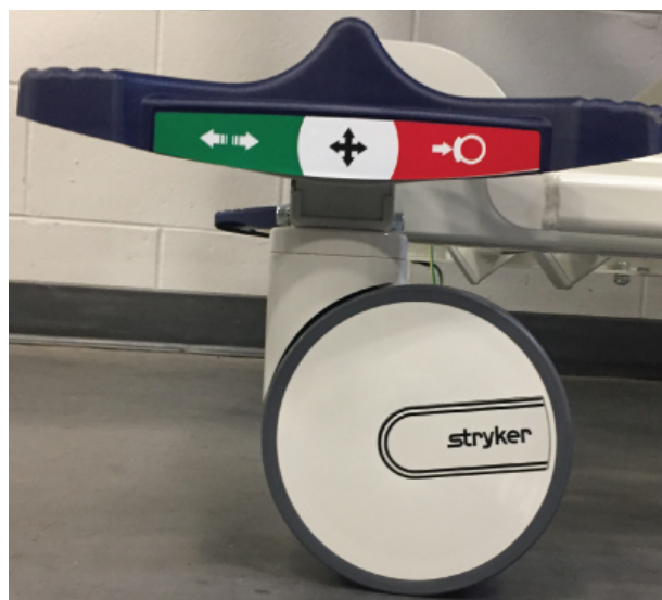
Figura 16-10: Eliberarea pedalei de direcție
