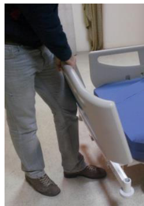
Εικόνα 13-17: Αφαίρεση ή αντικατάσταση της πλάκας των ποδιών
