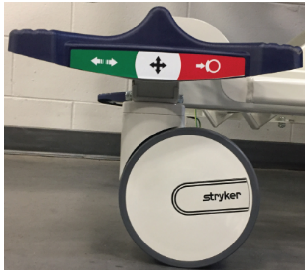
Abbildung 5-12: Anheben des fünften Rades
