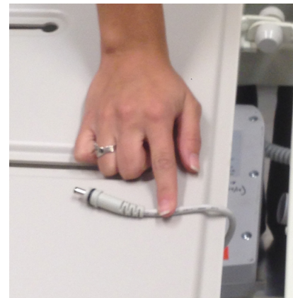
Kuva 11-5: Akkujohdon irrottaminen ohjausrasiasta
