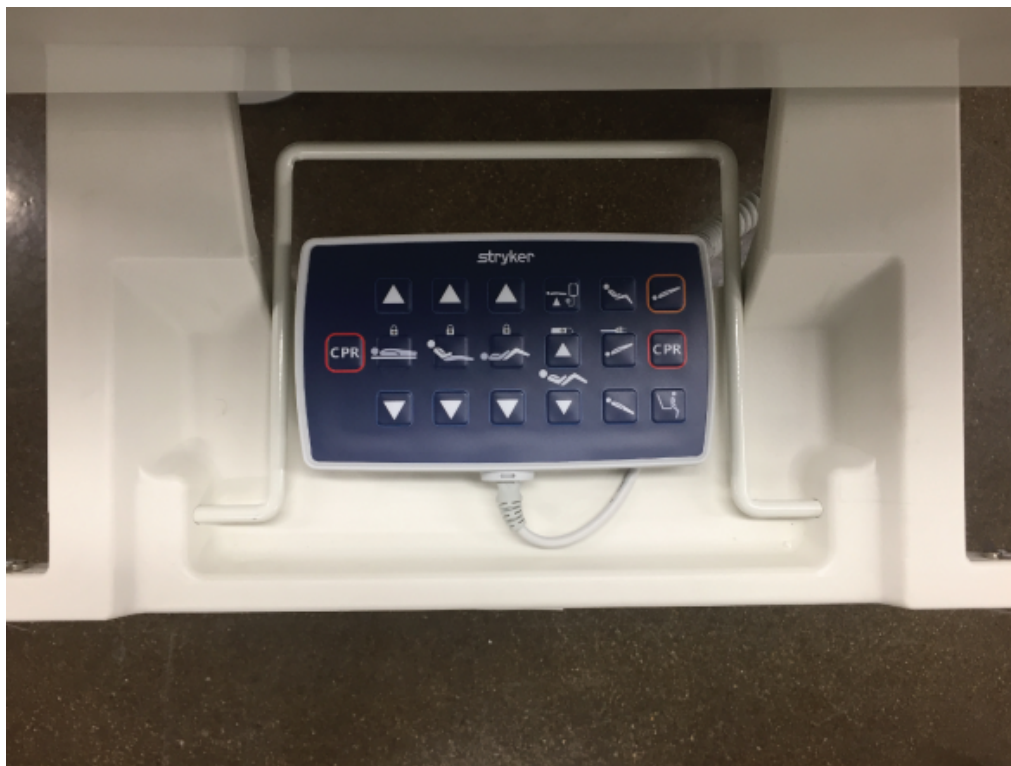
Figura 3-21: Guardar o controlo remoto da equipa de enfermagem
