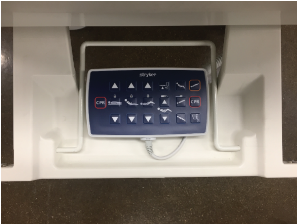
Kuva 11-21: Hoitajan käsiohjaimen säilyttäminen
