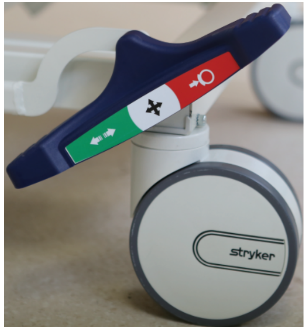
Abbildung 5-11: Absenken des fünften Rades
