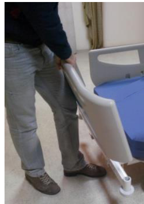
Abbildung 5-17: Entfernen oder Ersetzen des Fußteils
