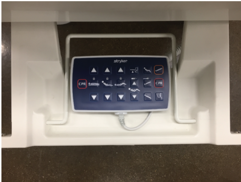
Obrázok 18-21: Uloženie ošetrovateľského ovládacieho panelu
