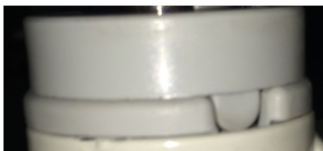
Figura 2-28: Bloqueo del soporte para la botella de oxígeno
