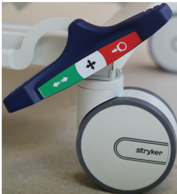
Figura 3-9: Acionar o pedal de condução
