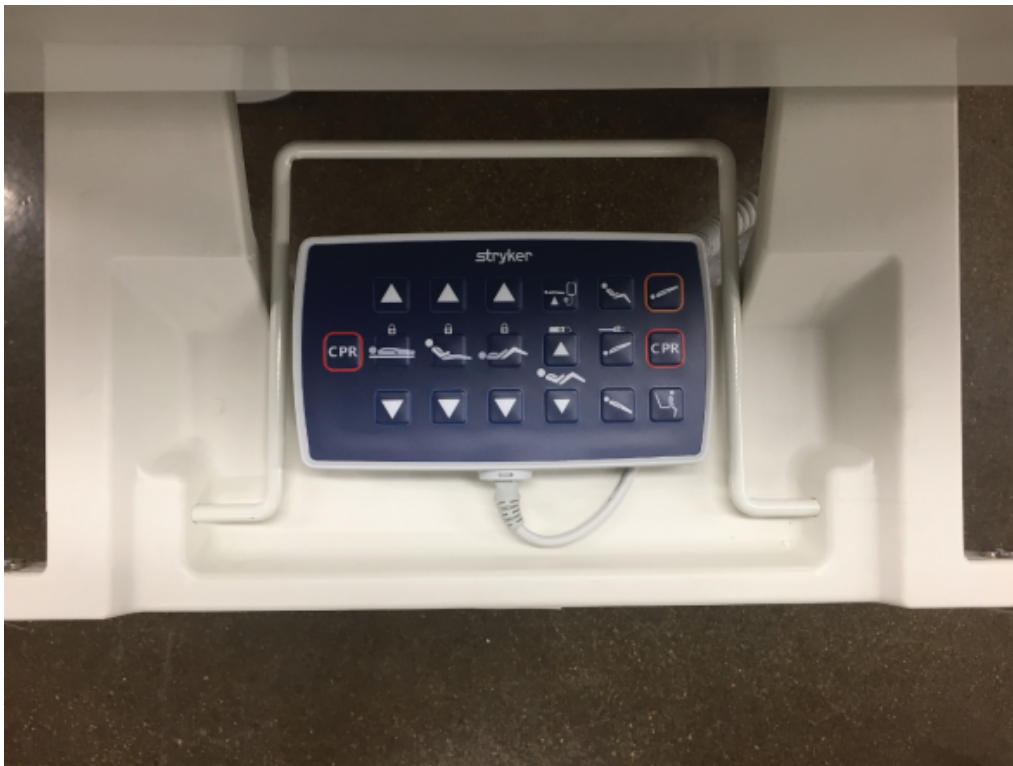
Figura 16-21: Depozitarea casetei suspendate cu butoane de comandă pentru asistenta medicală
