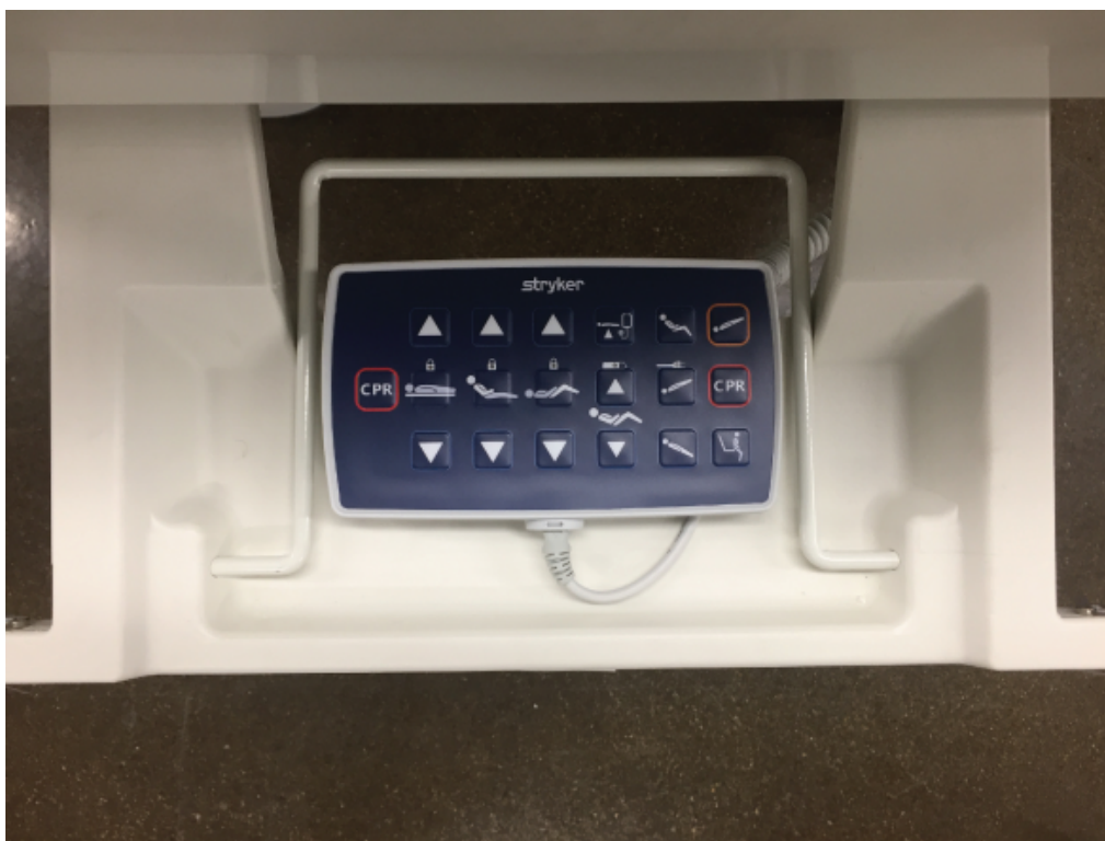
Rysunek 7-21: Przechowywanie pilota sterowania dla pielęgniarstwa
