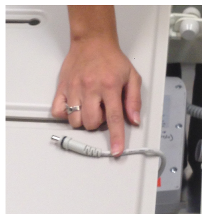
Slika 17-5: Iskapčanje kabela baterije iz upravljačke kutije
