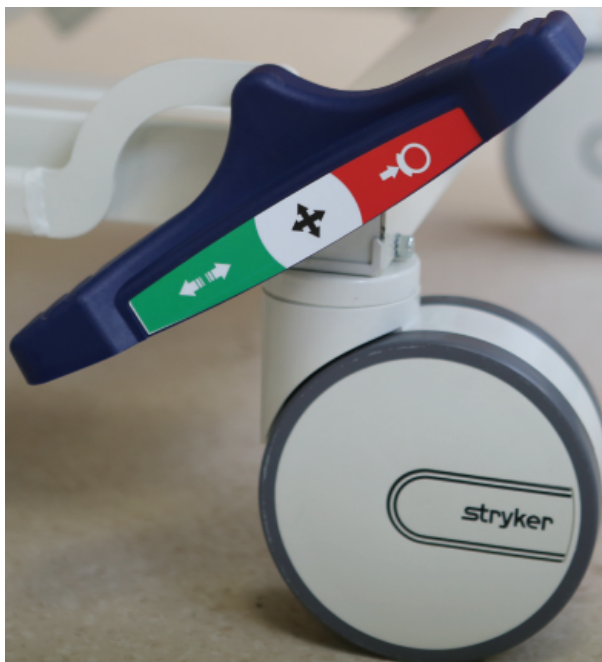
Figura 16-9: Acționarea pedalei de direcție
