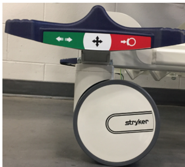
Figura 4-12: Disinnesto della quinta ruota
