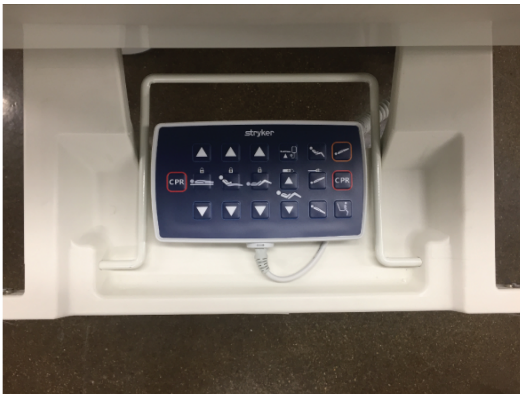
Fig. 9-21: Opbevaring af sygeplejerskens fjernbetjening
