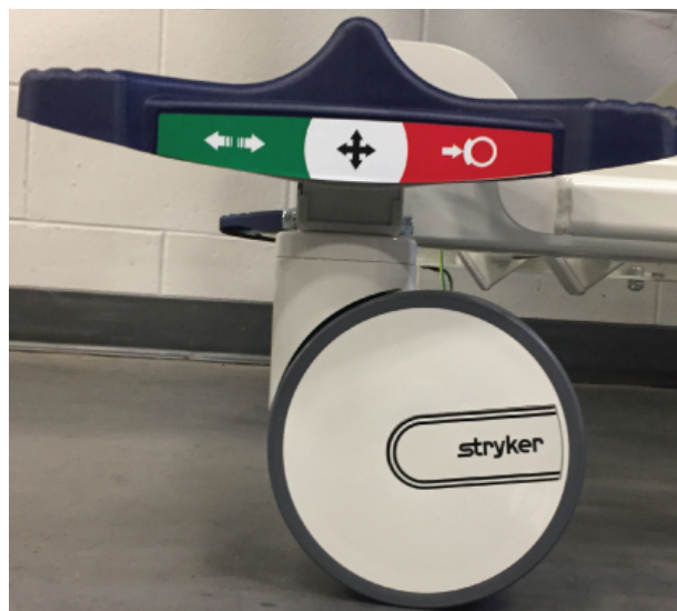
Slika 19-10: Sprostitev krmilnega pedala
