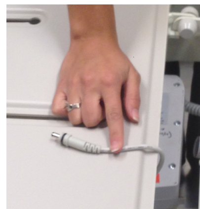
Abbildung 5-5: Ausstecken des Batteriekabels vom Steuerungskasten
