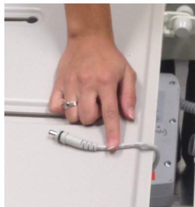
Slika 19-5: Odklop kabla akumulatorja iz kontrolne enote
