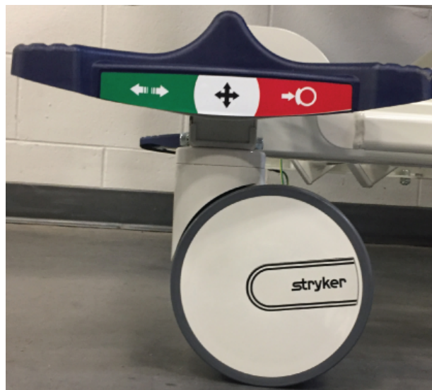
Kuva 11-8: Jarrujen vapauttaminen
