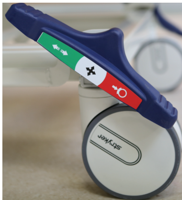
Obrázek 15-7: Zabrzdnění brzd
