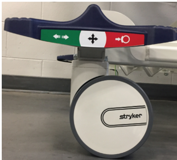
Figur 10-10: Koble ut styrepedalen
