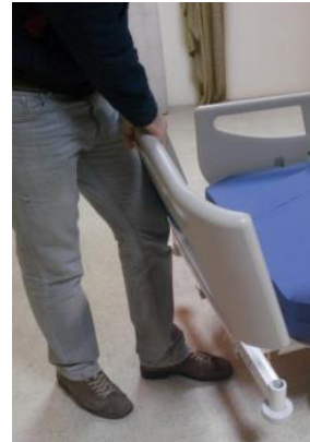
Figura 4-17: Rimozione e reinstallazione della pediera
