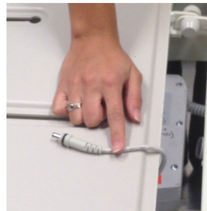
Figure 6-5 : Débranchement du câble de la batterie du boîtier de contrôle
