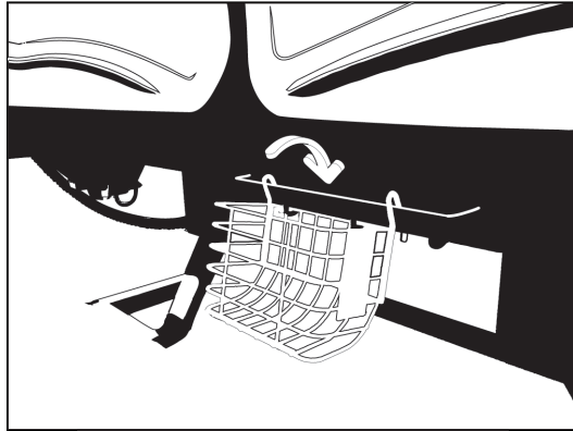
Εικόνα 13-29: Εγκατάσταση του καλαθιού ασκών Foley
