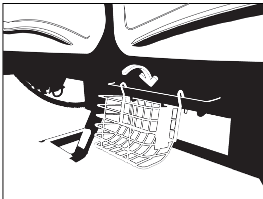
Figura 16-29: Montarea coșului pentru punga Foley
