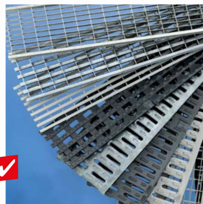
Zróżnicowane kształty rusztów - mostkowe, kratowe oraz cztery materiały (żeliwo, tworzywo sztywne, stal ocynkowana oraz stal nierdzewna ).
