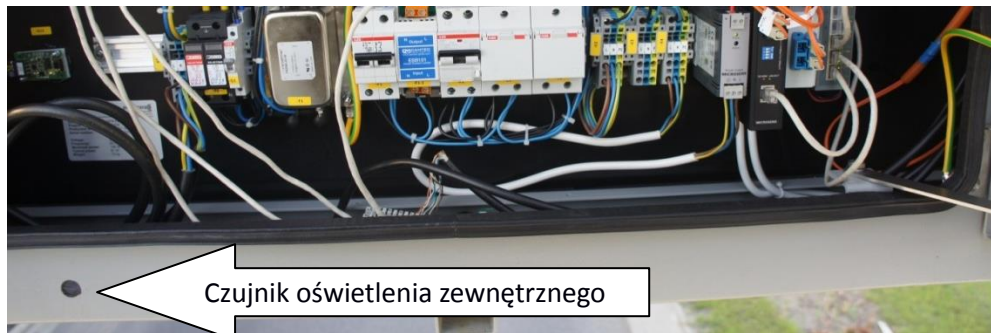
Rys. Dolna część znaku LCS „Master” – widoczny układ zasilania, segment komunikacji z systemem nadrzędnym oraz czujnik oświetlenia zewnętrznego.
