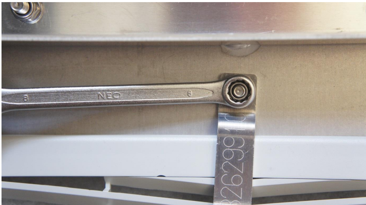
Rys. Poluzować nakrętkę od zabezpieczenia obudowy filtra. Zastosować klucz „8”.
