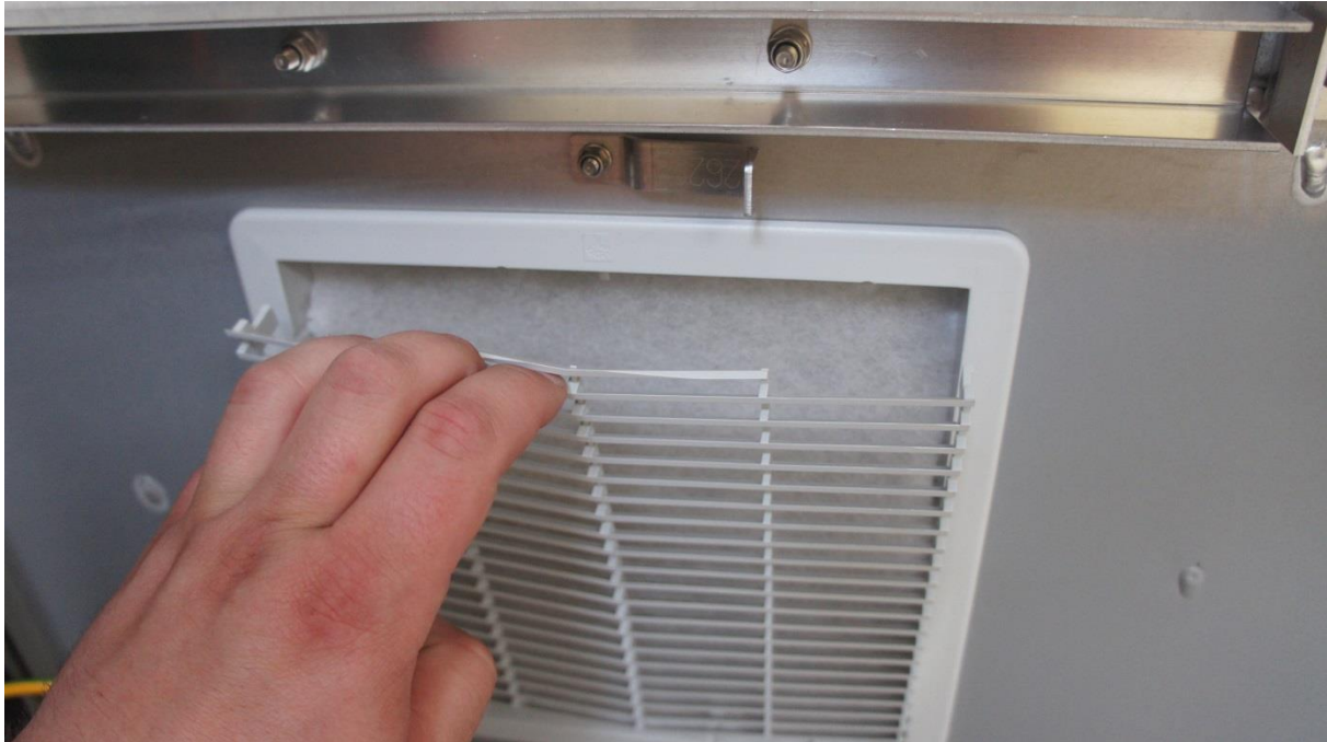
Rys. Pociągnąć do siebie kratkę obudowy filtra.
