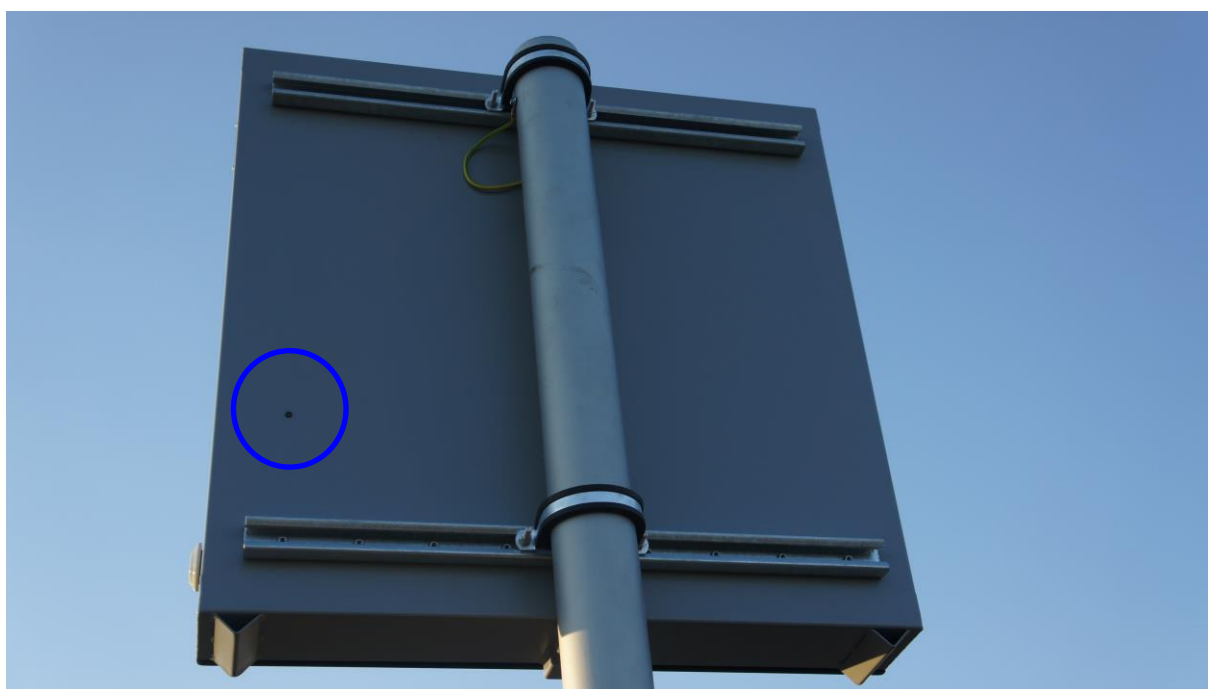
Rys. Czujnik oświetlenia z zewnątrz. Sprawdzić czy czujnik nie jest zabrudzony – jeśli zabrudzony przetrzeć wilgotną szmatką
