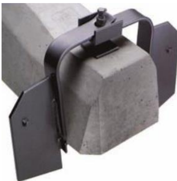
Rys. 6.4.2. Przykład profilu stalowego mocowanego do podkładów lub podrojazdnic, których zadaniem jest zwiększenie oporu poprzecznego toru w konstrukcji podsypkowej
