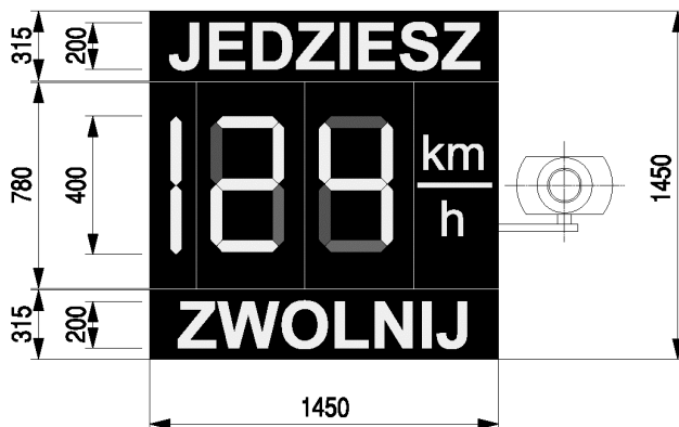
Rys. 13.6.1. Przykładowy wyświetlacz prędkości rzeczywistej z detektorem radarowym
