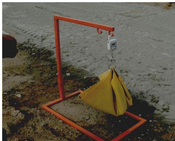
Ważenie tacki pomiarowej z cementem
