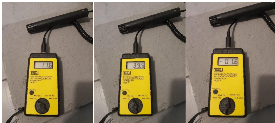
Fot. 70, 71, 72 Pomiar parametrów ciepło-wilgotnościowych wewnątrz pomieszczenia piwnicznego (Mikroprocesorowy miernik wilgotności powietrza Tanel WCM-1), od lewej: temperatura powietrza 11,6°C, wilgotność względna powietrza: 39,5%, temperatura punktu rosy: - 1,6°C.
