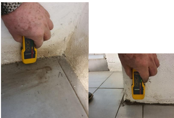
Fot. 68, 69 Ściana zachodnia – wejście na najniższy poziom piwnicy, prawy filar - pomiar wilgotności strukturalnej przy użyciu sondy radiowej (Protimeter SurveyMaster SM, krzywa kalibracji wg miernika karbidowego CM-Gerat): wynik 12% - ściana silnie zawilgocona. Po prawej: ściana zachodnia, lewy filar przy wejściu, wynik: 3% - ściana sucha.
