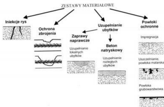
Fot. 56. Sposób wykonania naprawy konstrukcji żelbetowych pochodzący z wytycznych ABC-Ściany
