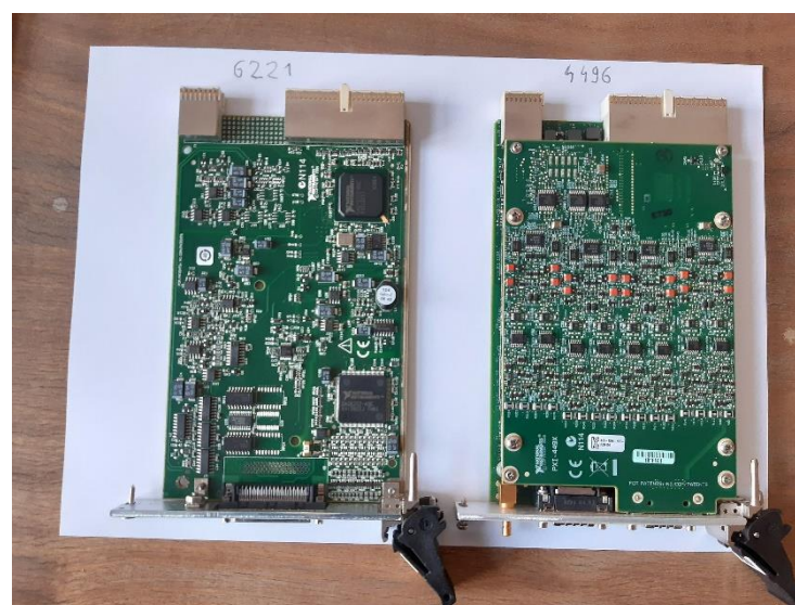
Rys 1. Widok kart NI PXI-6221 (po lewej) oraz NI PXI-4496 (po prawej)
