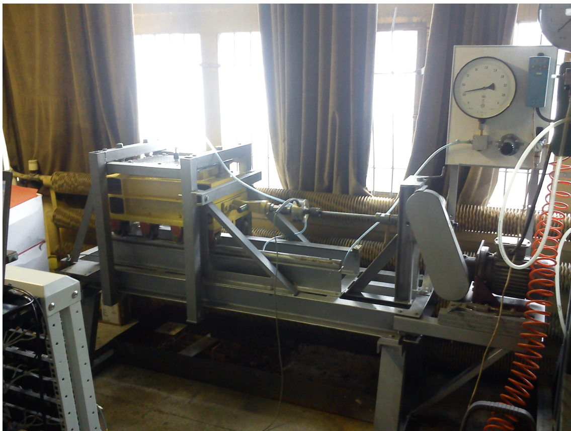
Istniejący duży aparat skrzynkowy do tzw. odtworzenia
