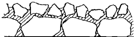
Rys. 3. Schematyczny obraz powierzchniowego utwalenia nawierzchni typu „sandwich”
