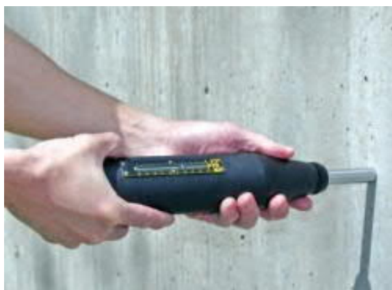
Sklerometr (Młotek Schmidta) typu N
