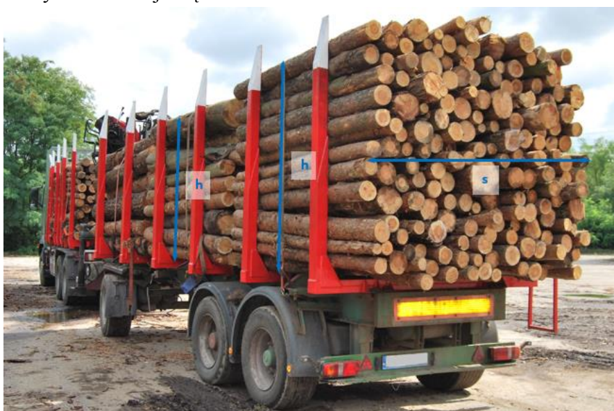
Ryc. 19. Pomiar kontrolny drewna na pojeździe wywozowym
