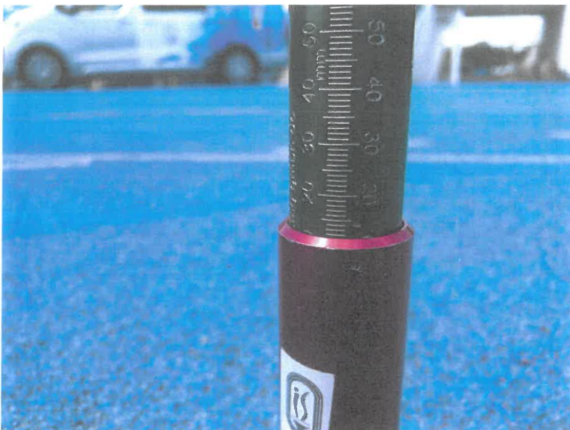
Fot. 4 Pomiar grubości nawierzchni bieżni
