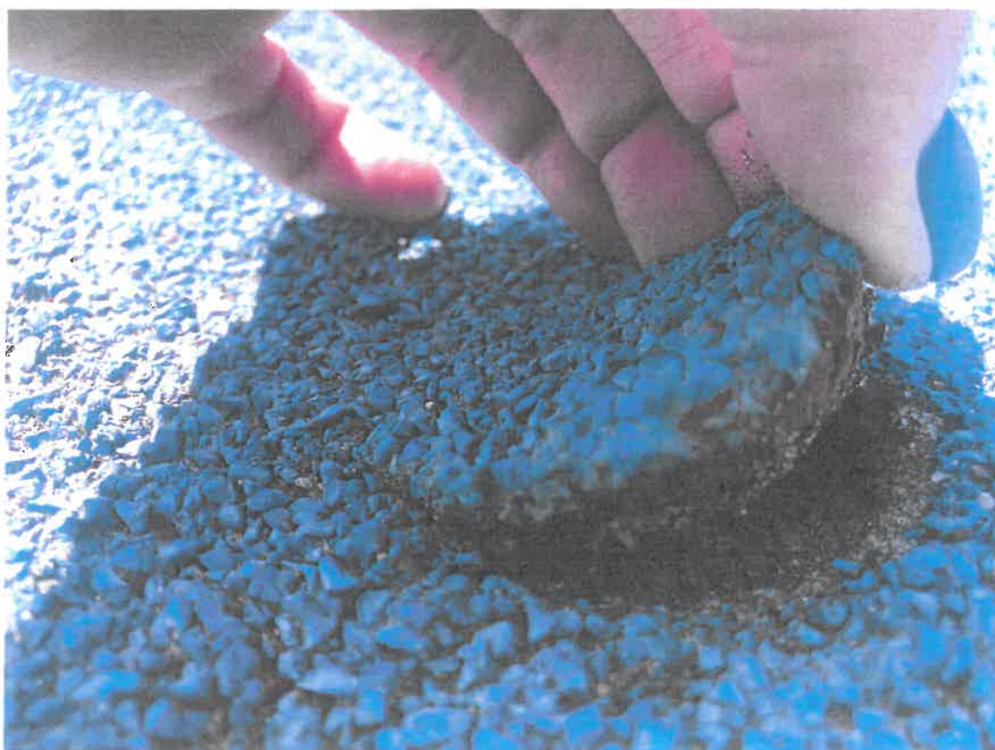
Fot. 5 Mechaniczne uszkodzenie nawierzchni
