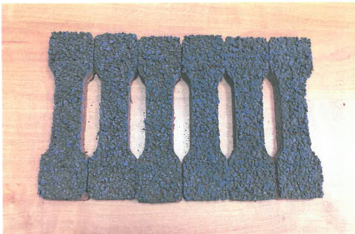
Fot. 7 Próbkki przygotowane do badań wytrzymałościowych
