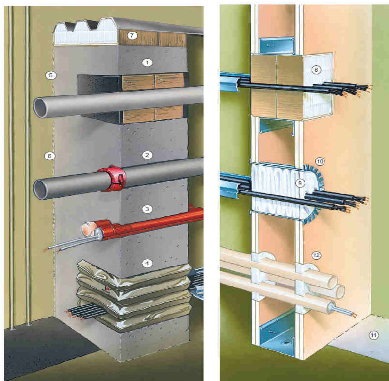
Rys. 2. Zabezpieczone przepusty instalacyjne
