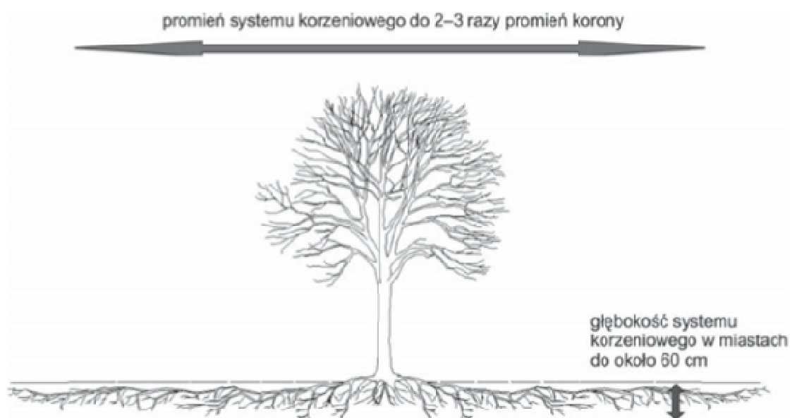
Rys. 1. Kształt i zasięg systemu korzeniowego w warunkach miejskich – schemat budowy (rys. M. Suchocka)
