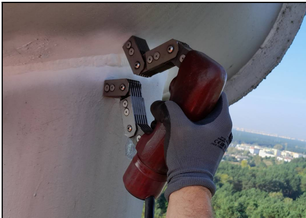
Fot.12 Badania magnetyczno proszkowe na kłosie nr 1
