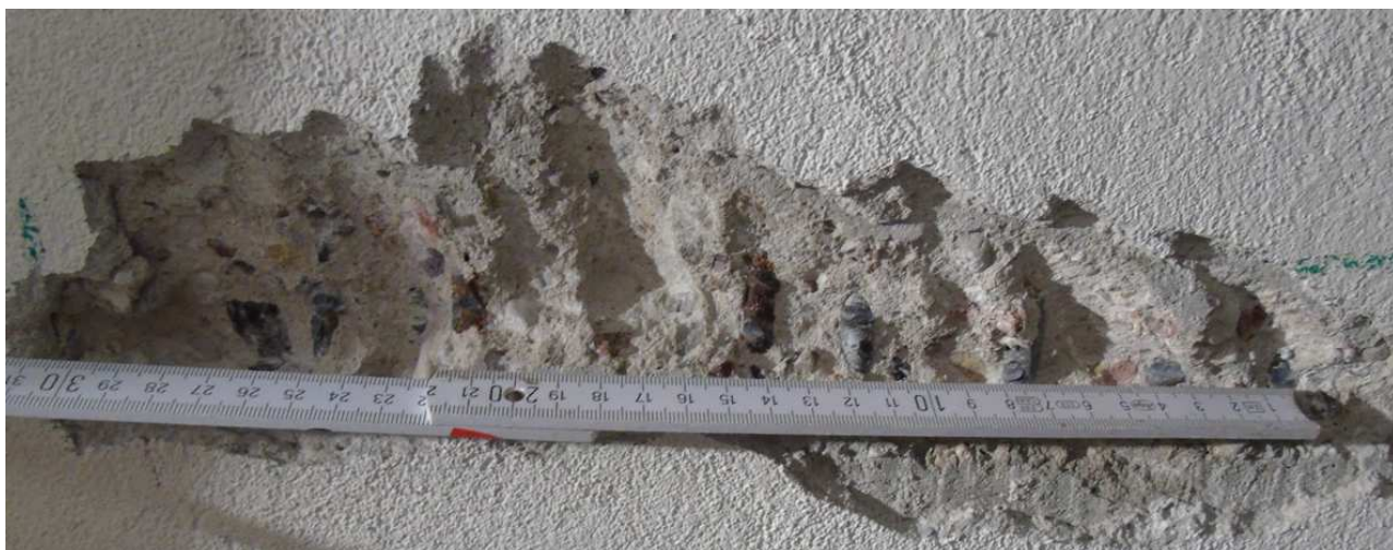
Fot.OS2. Odkrywka prętów zbrojeniowych wykrytych metodą nieinwazyjną.
