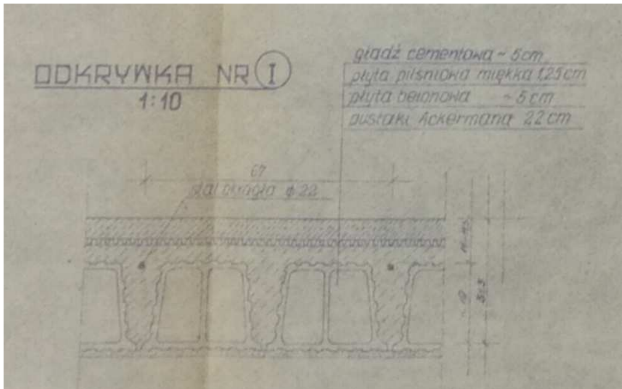
5. Opis odkrywki nr I na stropie po drugiej stronie korytarza. Widoczny wymiar pustaka ok. 19cm. W opisie warstw przekrojowych błędnie opisano wymiar pustaka jako 22cm zamiast 20cm. Na przekroju brak oznaczenia płyty grzejnej pod stropem Ackermana z uwagi na fakt, że odkrywki wykonywano od góry stropu.
