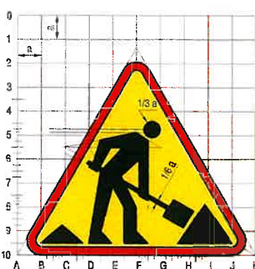
A-14 „Roboty na drodze”
