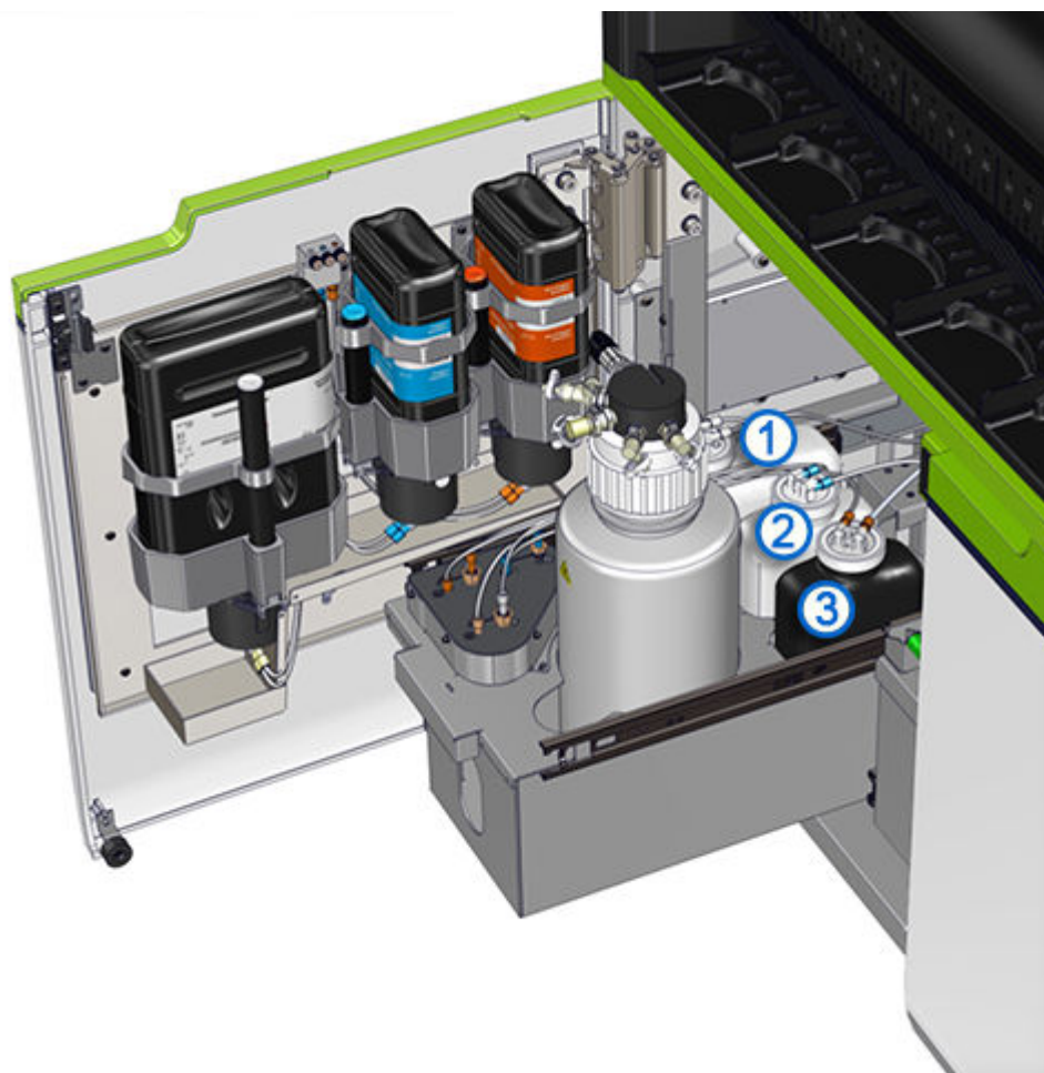
Ilustracja 173: Podzespoły zbiorników roztworów roboczych (i-series)
