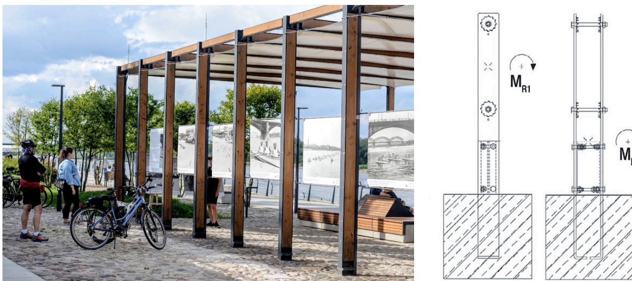
Ryc. 32: przykładowa forma prostej pergoli wykorzystanej do prezentacji wystawy plenerowej / Warszawa, Bulwary Wiślane oraz schemat konstrukcji kotwy słupa pergoli
