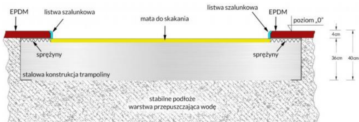
Zdj.5 – montaż trampoliny
